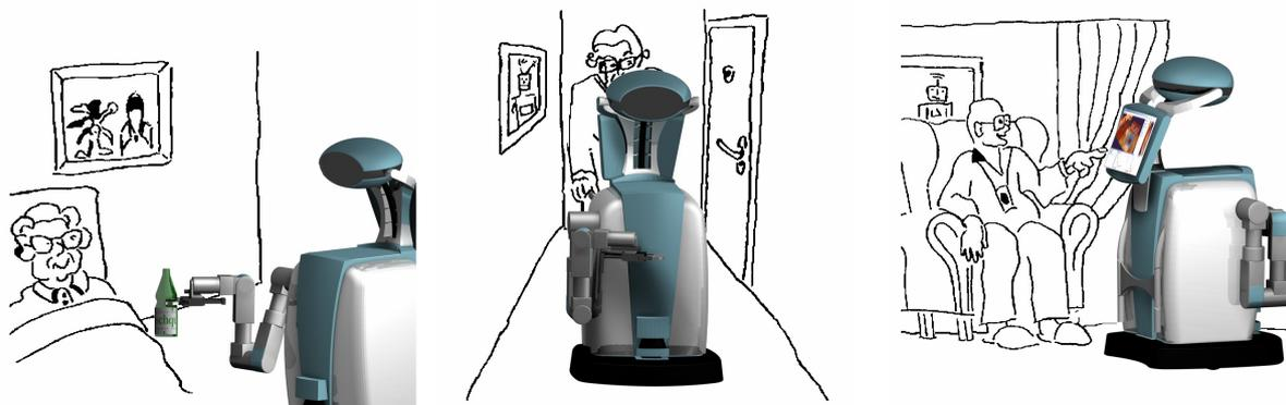
**Bild 1** Mögliche Funktionen des Roboterassistenten: Transporthilfe, Gehhilfe, Kommunikationsschnittstelle.
