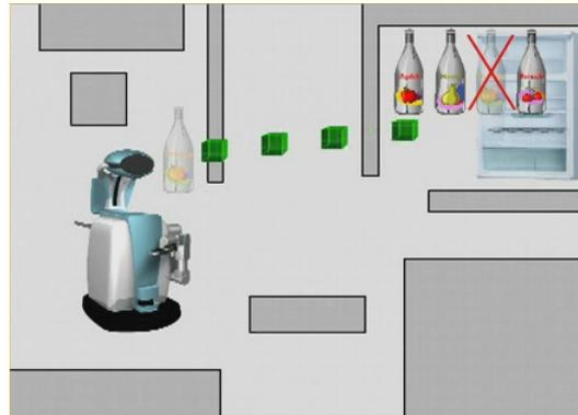
**Bild 6** Übertragung des Getränkebestands vom smarten Haussystem an den Roboterassistenten.
