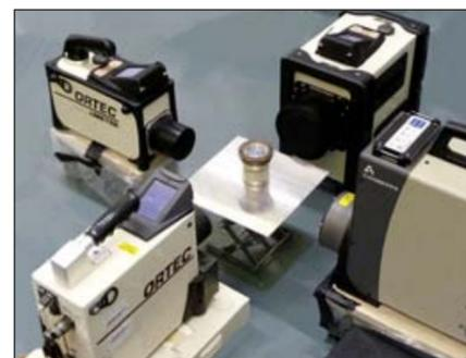
Abb. 2: Exemplarischer experimenteller Aufbau mit den vier Detektoren um eine nicht abgeschirmte Plutonium-Quelle herum platziert; die Detektoren sind im Uhrzeigersinn von unten links aus: Detective EX, Micro-Detective, Detective 200 und Falcon 5000
