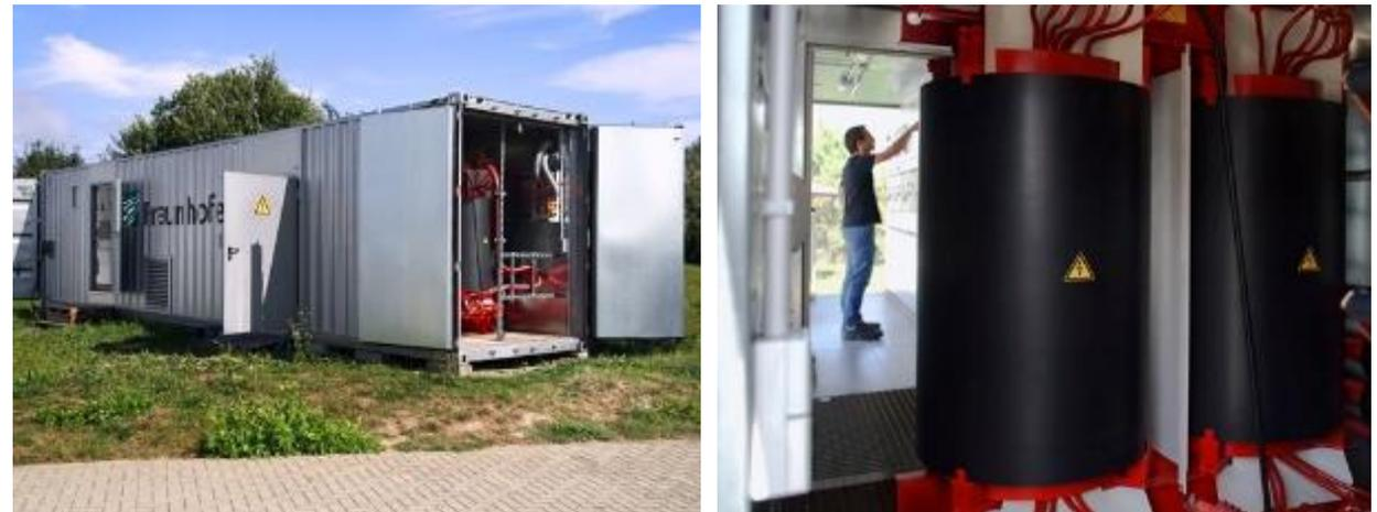
6 MVA OVRT-Prüfeinrichtung, Fraunhofer IEE, SysTec-Labor
