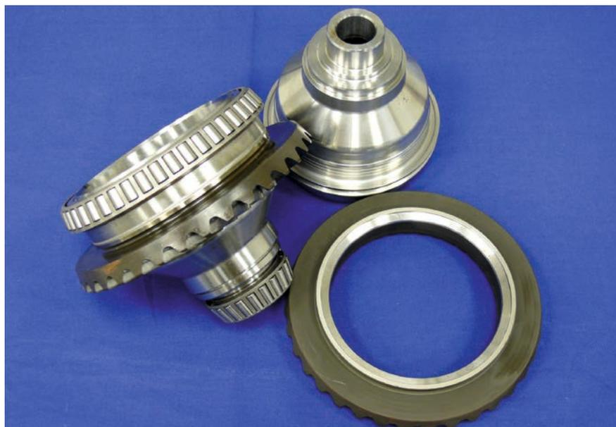
Getriebebauteile geschweißt (links) und Einzelteile nach dem Laserabtragen der grauen Phosphatschicht (rechts)
