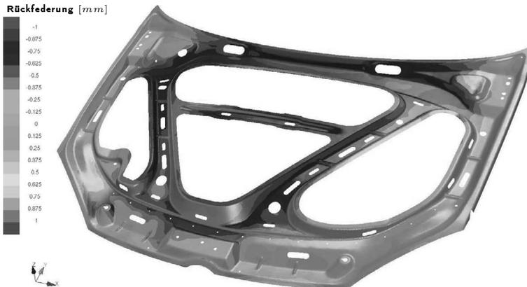
Abbildung 5.3.: Rückfederung Referenzbauteil Frontklappe innen VW Golf 5
