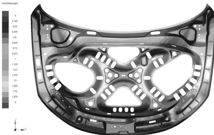
Abbildung 5.8.: Rückfederung der Ausgangs CAD-Geometrie der Frontklappe innen VW EOS
