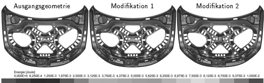
Abbildung 5.6.: Energetischer Zustand, Frontklappe innen VW EOS
