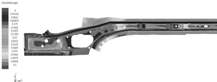
Abbildung 5.11.: Unschärfe bei der Beurteilung von Rückfederungen am Längsträger PQ-Mix
