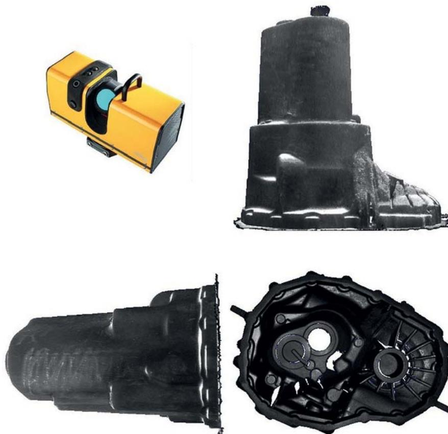
Abbildung 3: Mit einem einzelnen Surphaser-Scan erfasste Innenkontur eines Getriebegehäuses 400 mm x 300 mm x 400 mm.
