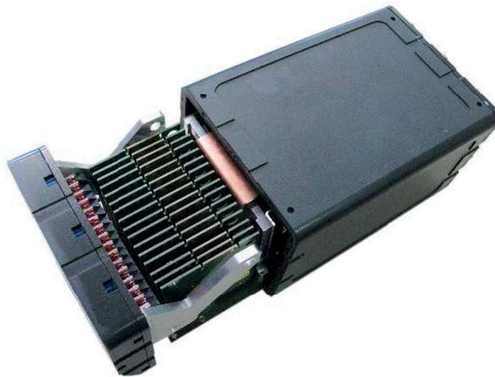
Abbildung 1: Fächerecholot mit Antenne und Beamformer
