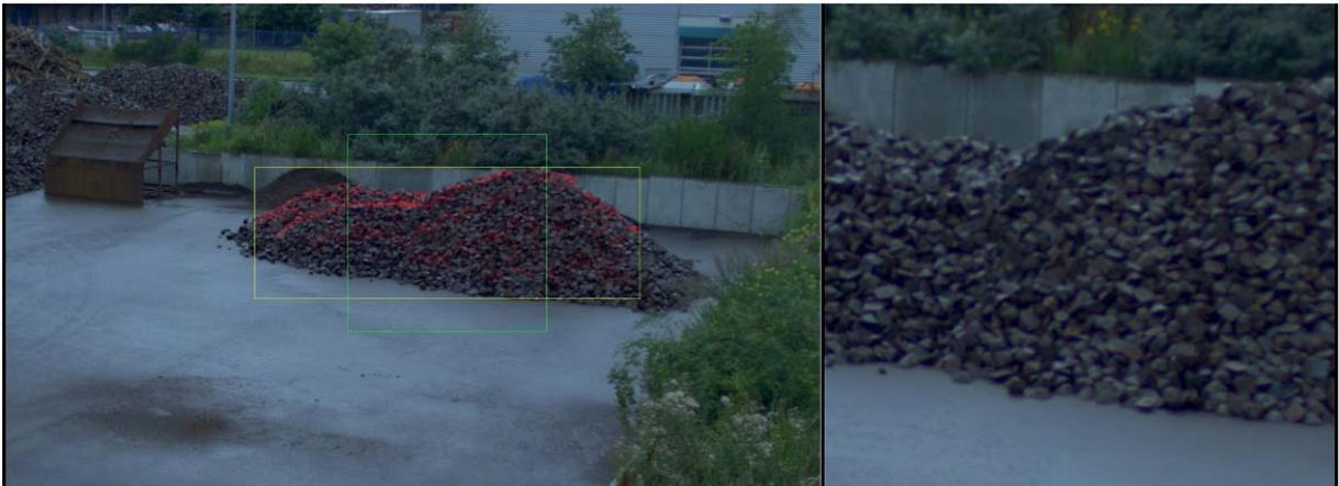
Abbildung 6: Links: Rektifizierte linke Ansicht der Stereo-Aufnahme mit rücktransformierter Belegung (rot) und weiterzuverarbeitender Bereiche (Rechtecke)
