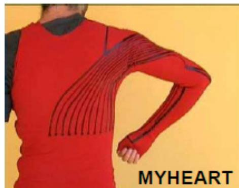
Textil mit aufgedruckten piezoresistiven Fasern zur Analyse von Bewegungen
