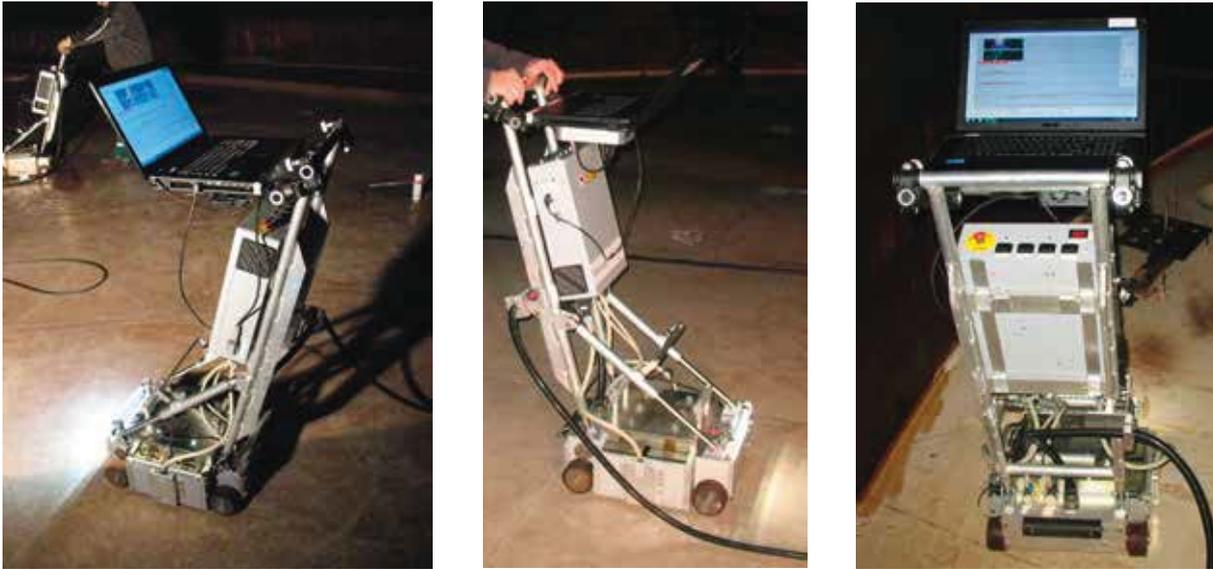
Abbildung 1: FIT-Tankbodenprüfgeräte im Einsatz.
