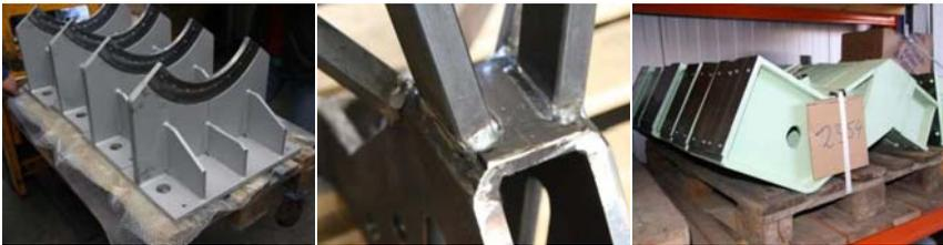
Bild 7.9: Typische Schweißkonstruktionen gefertigt bei Fa. Treffler: Lagersitze, landwirtschaftliche Maschinen, Galerieträger (v.l.n.r.)
