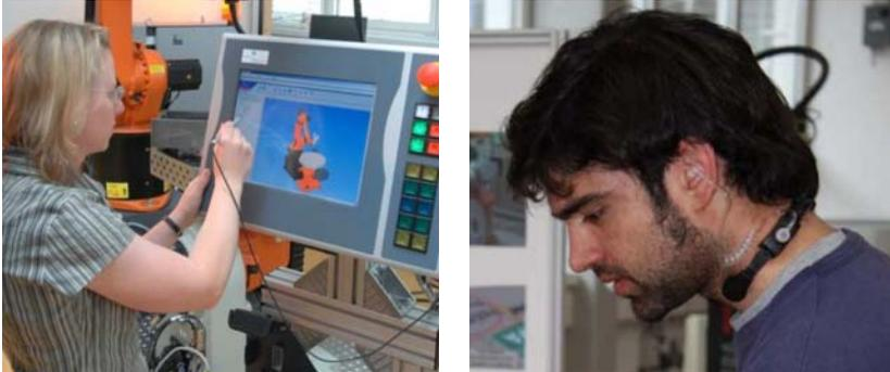
Bild 7.3: Interaktion mittels Touchscreen (links) und Sprachinterface mittels Kehlkopfmikrofon (rechts)
