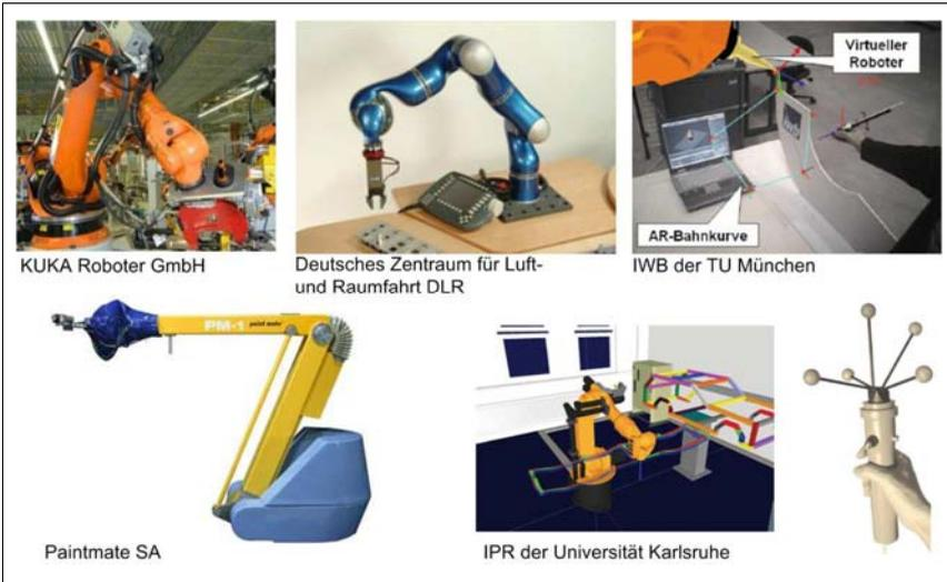
Bild 2.2: Beispiele für durch Vormachen programmierbare Roboterzellen
