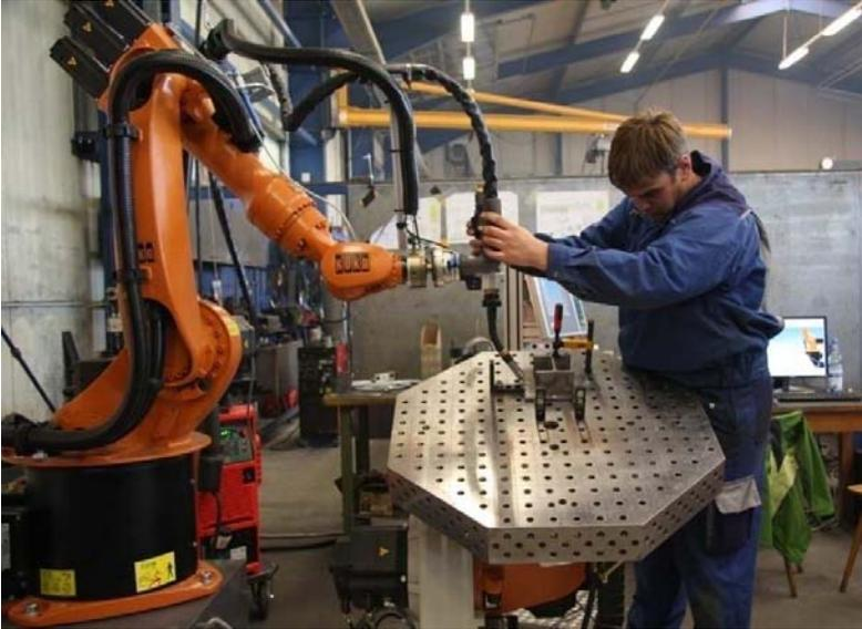
Bild 7.10: Test der in der Fertigung aufgebauten Schweißroboterzelle durch einen Mitarbeiter der Fa. Treffler
