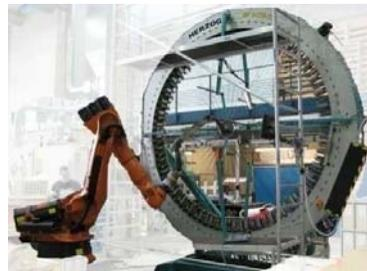
Bild 3.10: Kleinserien- und Prototypenfertigung mit Industrierobotern (links: Bolzenschweißen, rechts: Wicklung von CFK-Rohlingen)
