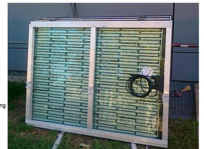
Rückseitenansicht eines TPedge-Moduls mit Montagerahmen und Verschaltung der HIP-MWT-Solarzellen.
