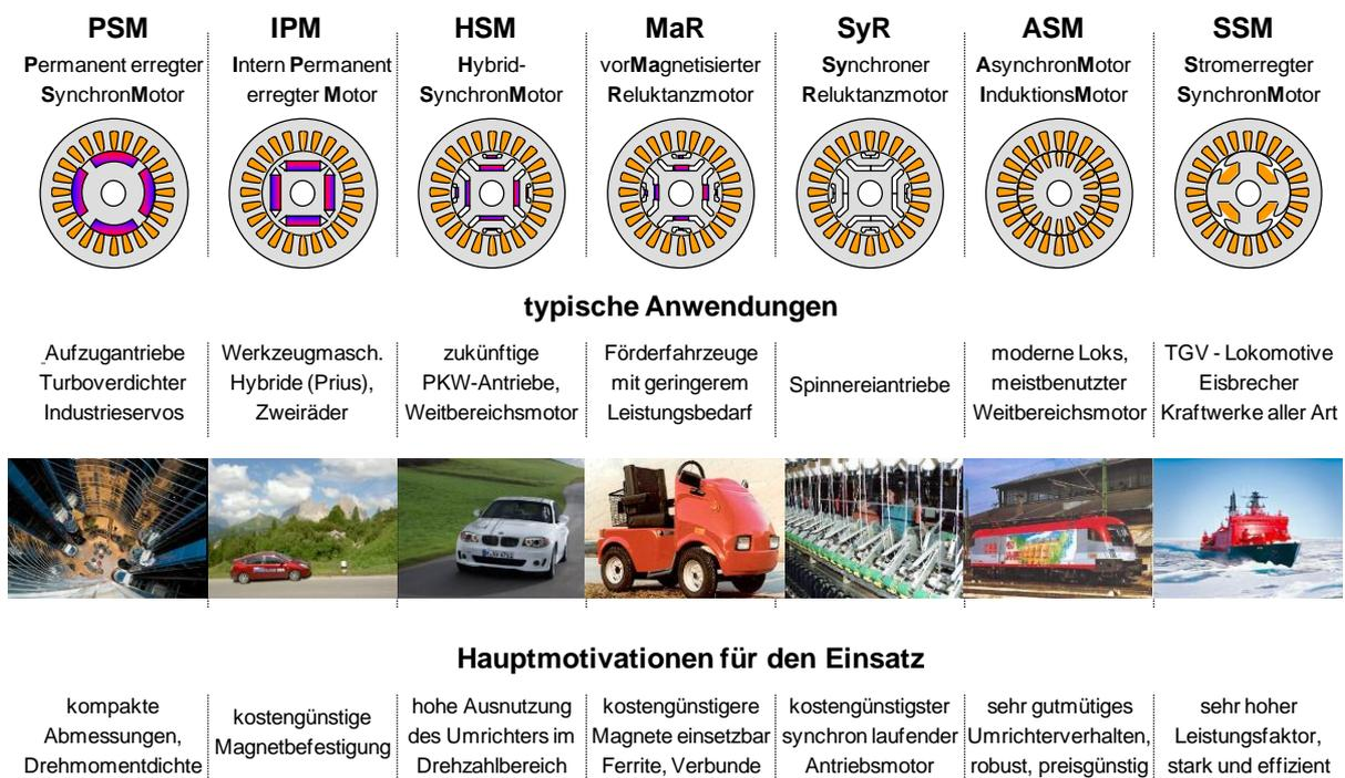
Abbildung 32: Bauarten elektrischer Maschinen im Überblick
