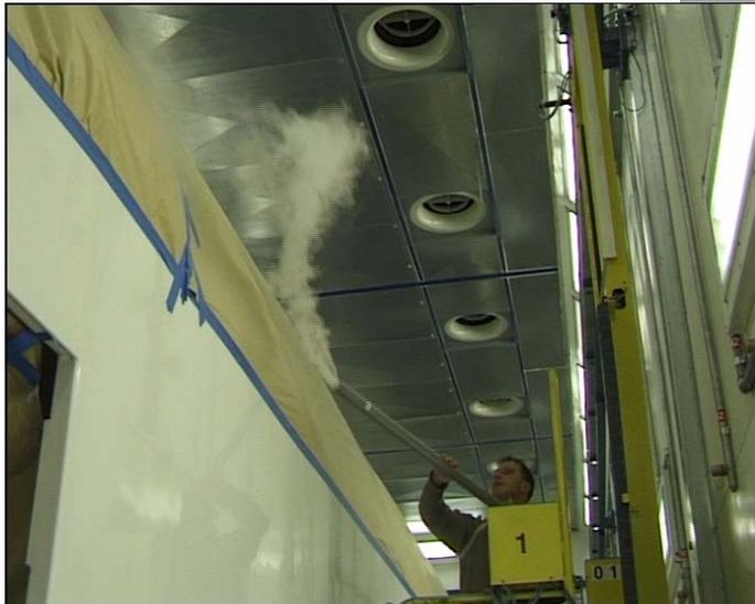
Visualisierung der Luftströmung mittels Nebelfluid in einer Lackieranlage für Schienenfahrzeuge
