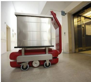
**Bild 3** CASERO fährt zur Abgabe des Wäschebehälters mit dem Fahrstuhl in den Keller
