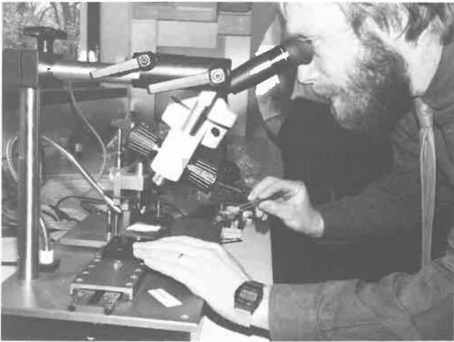
**Die Arbeit an den Bauelementen der kleinen Schutzschalter verlangt den Mikroskopeinsatz.**
