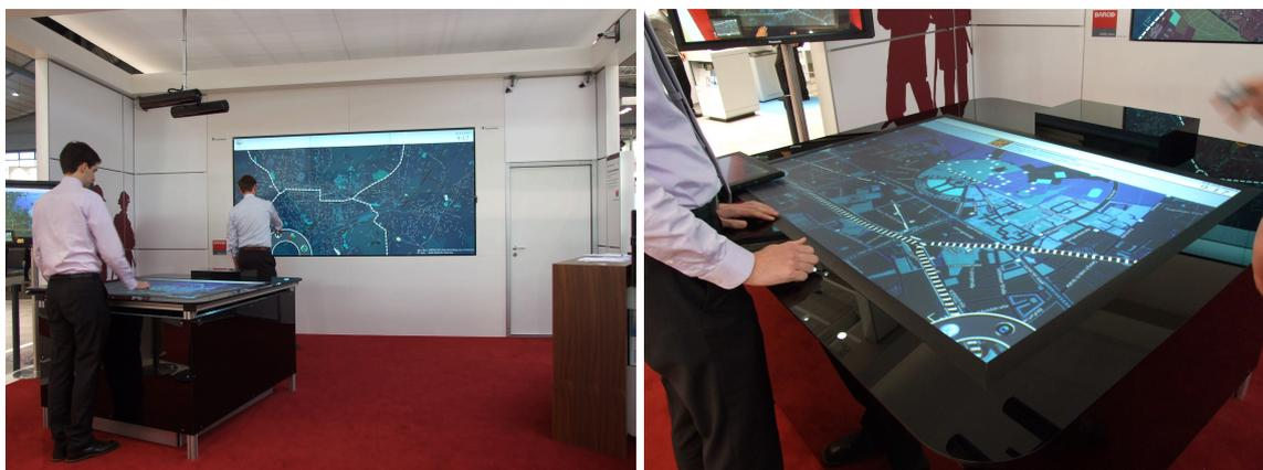
Abb. 5.7.: Verdeutlichung des angehefteten Arbeitsbereichs: im linken Bild ist der Mitarbeiter noch an der Videowand beschäftigt. Weil das System seine Trajektorie verfolgt, wird sein Arbeitsbereich entsprechend an der Videowand angezeigt. Im rechten Bild ist der Mitarbeiter an das Tischdisplay zurückgekehrt (rechts im Bild teilweise sichtbar) - sein Arbeitsbereich wird nun automatisch in der rechten unteren Ecke des Tischdisplays eingeblendet.
