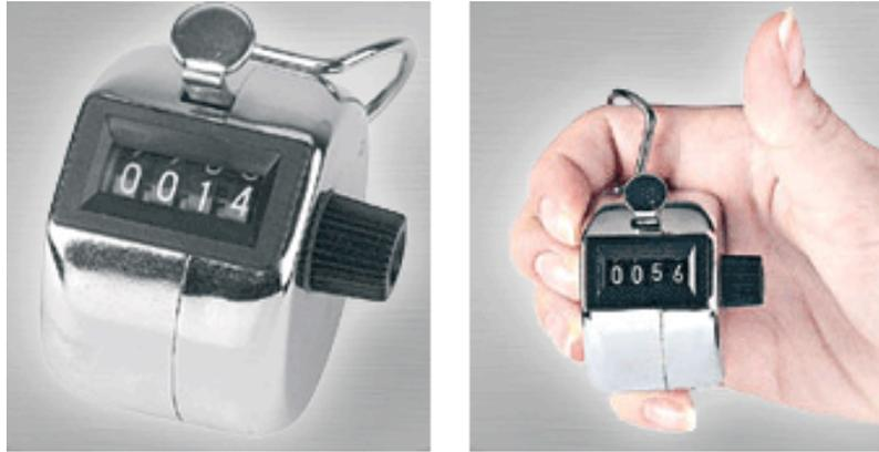
Abbildung 6.4: Zur Unterstützung des Zählvorgangs eingesetzter Handzähler
