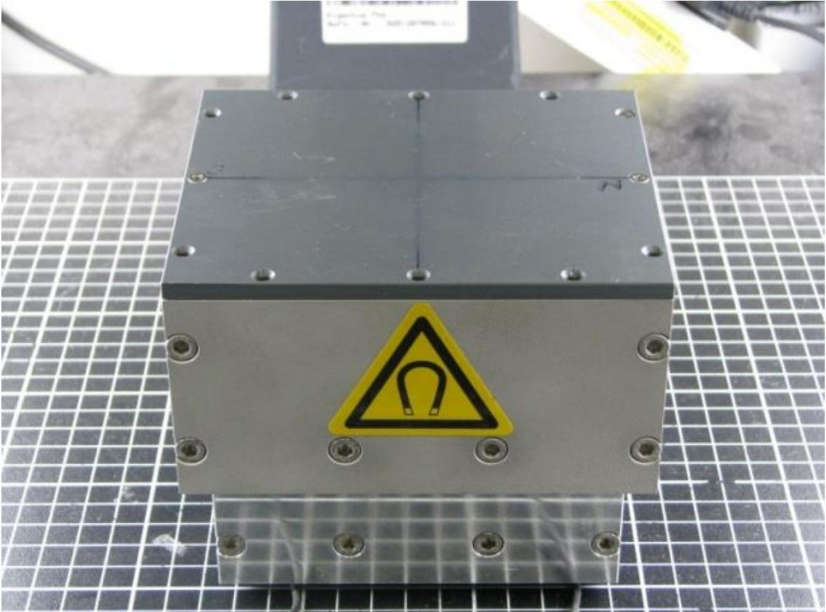
Abbildung 3-2: Foto des U-Magneten. in dessen Aluminiumgehäuse.
