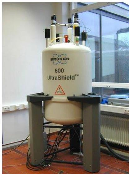
Abbildung 2-14: Bruker Avance 600 MHz NMR-Spektrometer [11].
