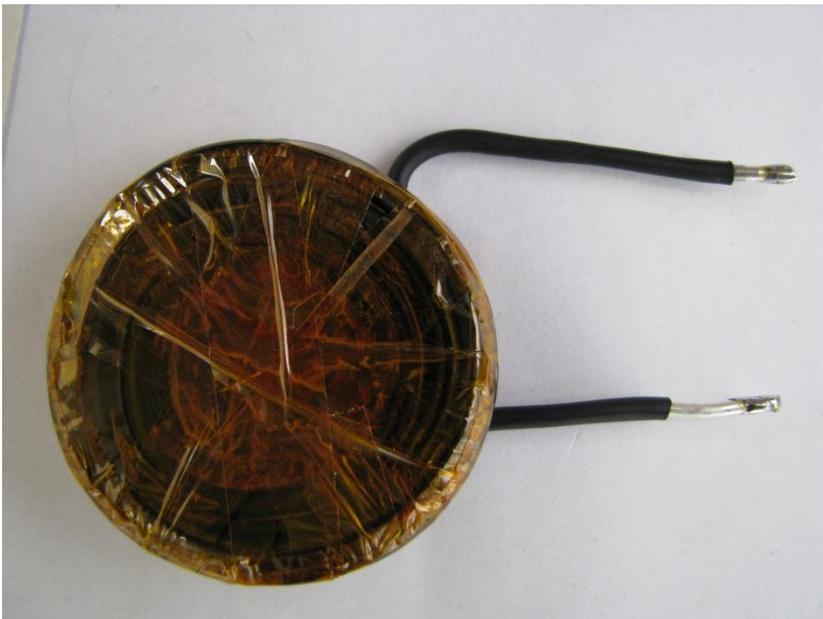
Abbildung 5-26: Finale Sende-/ Empfangsspule, bestehend aus 12 Windungen 2,0 mm dickem versilbertem Kupferdraht.
