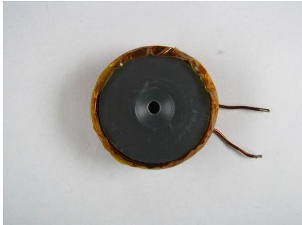
Abbildung 5-15: Zweilagige Zylinderspule mit 12 Windungen auf rundem Spulenträger
