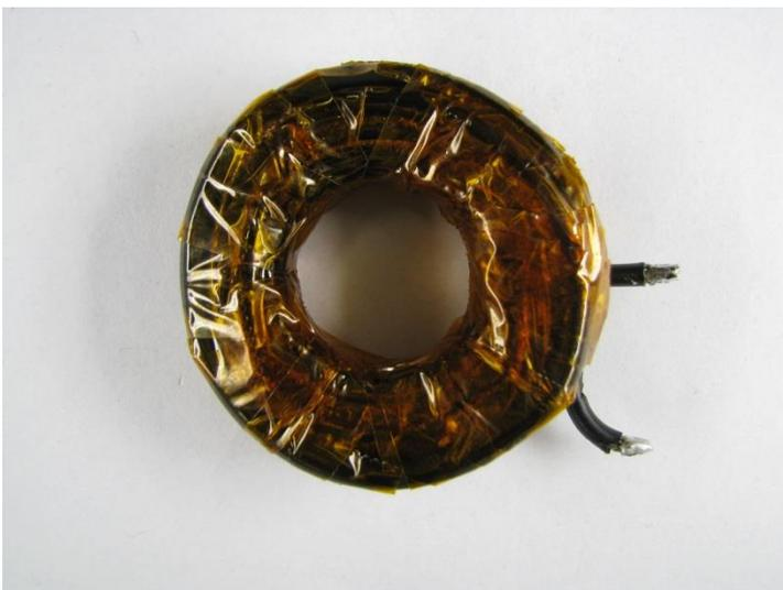
Abbildung 5-21: Zylinderspule aus 2,0 mm dickem Silberdraht bestehend aus 3 Lagen mit je 4 Windungen.
