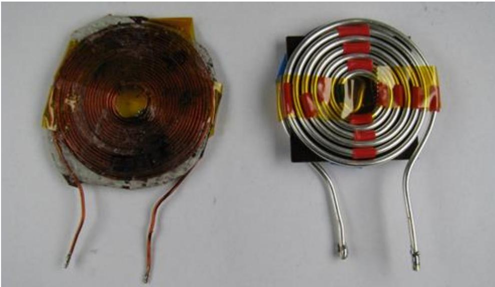
Abbildung 5-23: Sende-/Empfangsspulen ausgelegt als Pancake-Spulen
