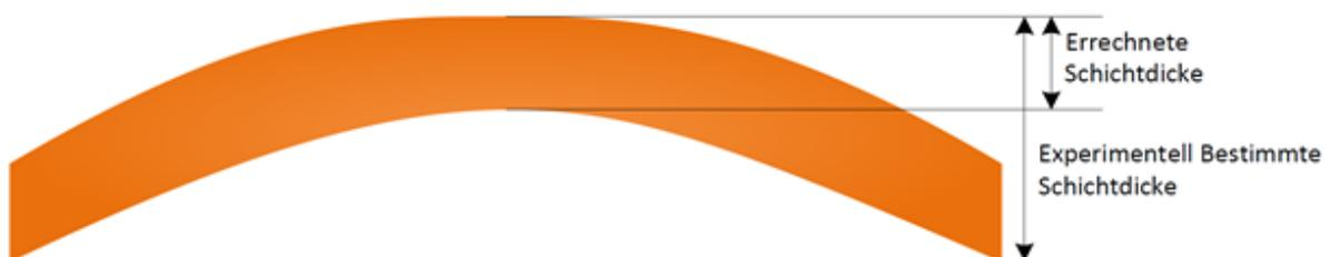
Abbildung 8-9: Skizze zur Verdeutlichung des Unterschiedes zwischen gemessener und rechnerisch ermittelter sensitiver Schichtdicke.
