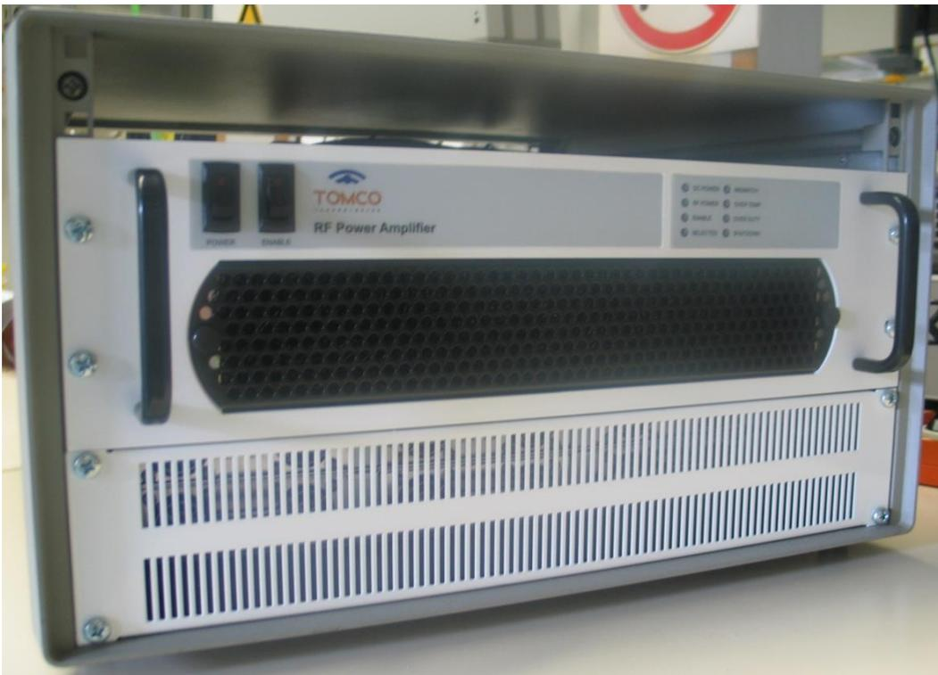
Abbildung 7-1: TOMCO 2kW RF Power Amplifier der Firma Tomco mit dazugehöriger Spannungsversorgung.
