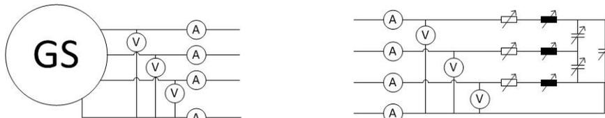
Abbildung 30: Messpunkte am Leistungsausgang des Diesellaggregats und der RLC-Lasten
