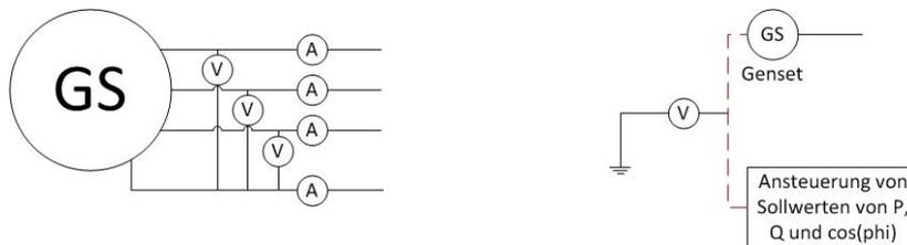
Abbildung 27: Messpunkte am Leistungsausgang des Aggregats und des Sollwertpegels an der Steuerung (Darstellung zeigt Messung bei Spannungssignal, bei Stromsignal Messung des Stroms)
