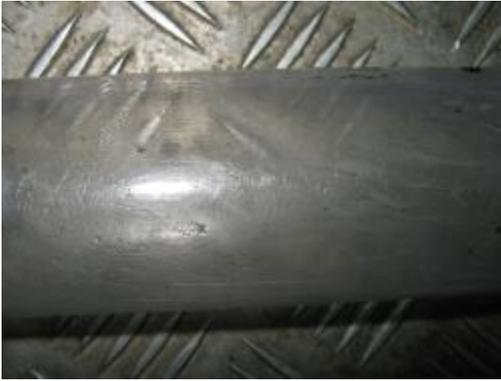
**Abb. 4-7:** Ausgebaute PVC-Folie nach dem Einsatz im Biowäscher
