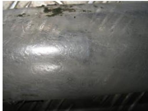
**Abb. 4-18:** Behandelte PVC-Folie nach dem Einsatz im Biowäscher
