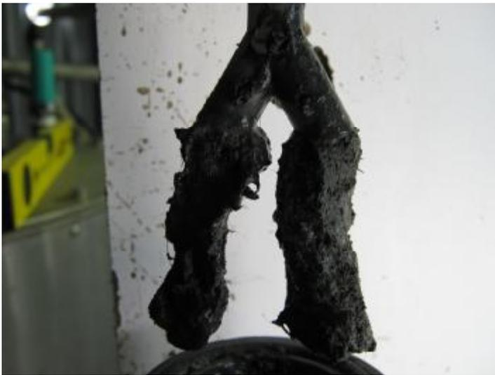
**Abb. 3-3:** Schaumstoffrührer zur Erzeugung des Fallfilms
