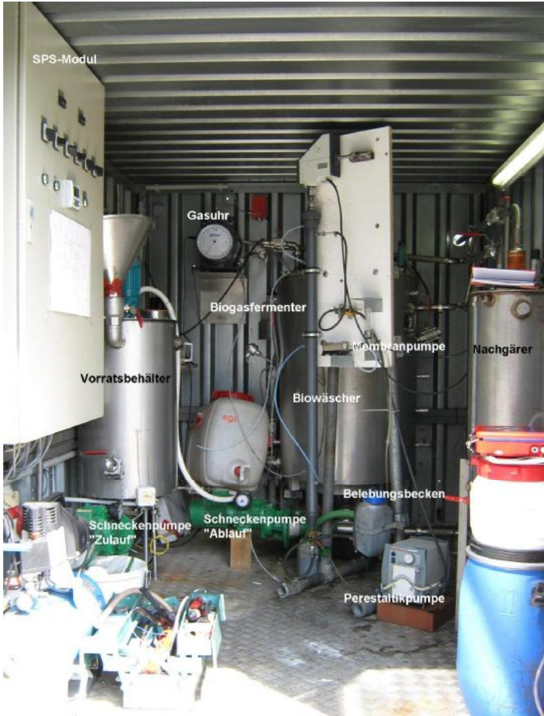
**Abb. 3-1:** Fotografische Darstellung der Biogasanlage und der biologischen Entschwefelung
