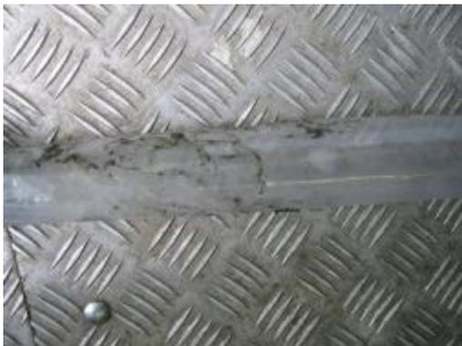
**Abb. 4-19:** Angeraute PVC-Folie nach dem Ausbau
