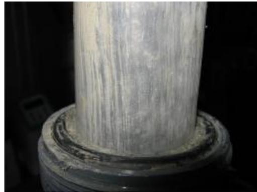
**Abb. 4-10:** PVC-Folie mit Schlammablagerungen im Biowäscher
