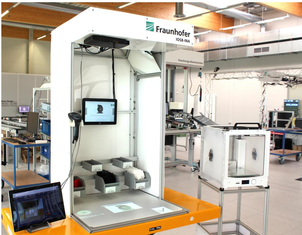
Abbildung 2: AR-Cube-Plattform zur In-Situ-Assistenz
