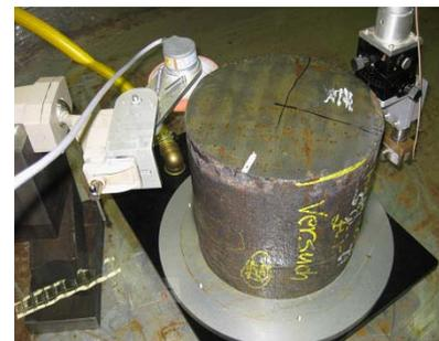
Abb. 11: Einschallschema bei der Stabstahlprüfung in Tauchtechnik
