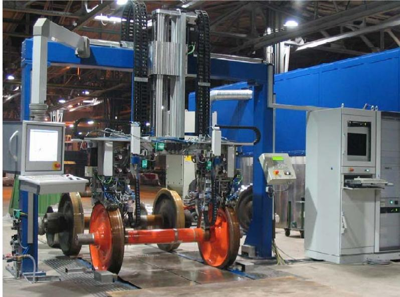
**Abb. 5:** Automatisierte Ultraschallprüfanlage
