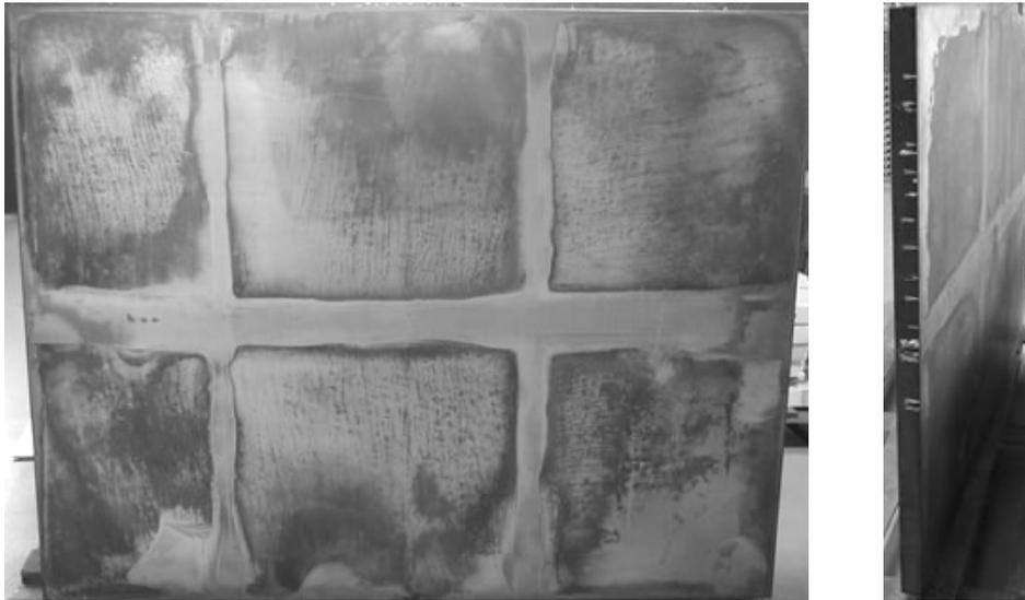
**Abb. 8** Vorder- und Seitenansicht des optimierten Sandwich
