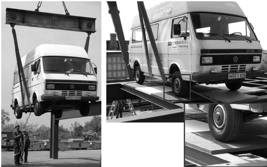
**Abb. 16** Belastung mit einem Kleinbus zum Nachweis der Tragfähigkeit
