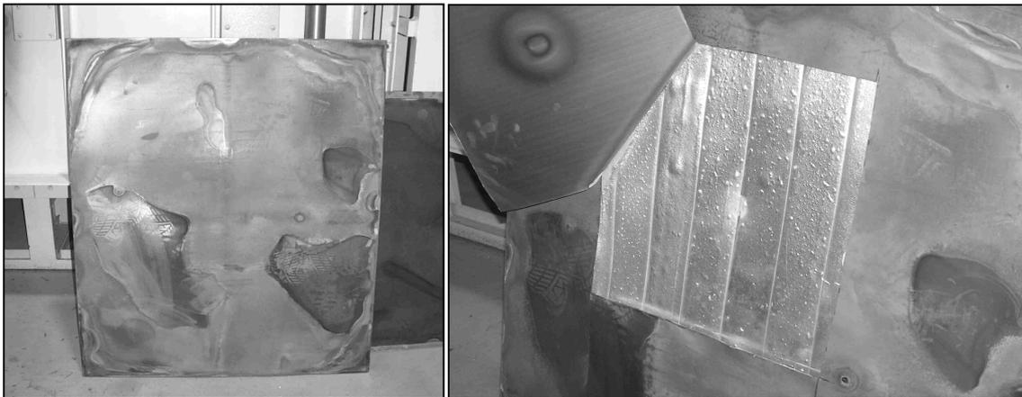
**Abb. 7** Sandwich nach Fehlschäumung
