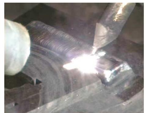
Bild 7: Video-Screenshot Werkzeugreparatur: Auftragschweißen (1. Lage)
