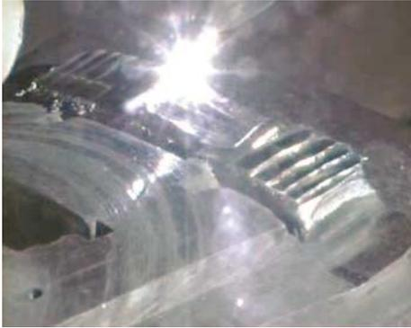
Bild 8: Video-Screenshot Werkzeugreparatur: Auftragschweißen (5. Lage)
