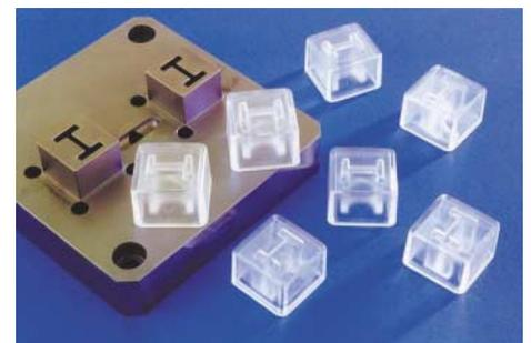
Bild 5: Mittels CMB gefertigte Spritzgießeinsätze und abgemusterte Bauteile
