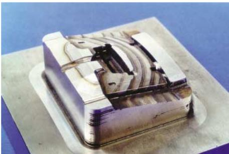
Bild 10: Mittels CMB gefertigter SG-Werkzeugeinsatz
