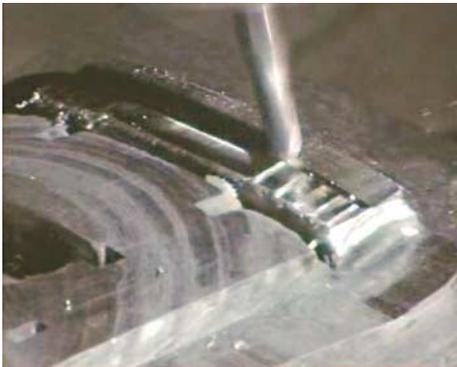
Bild 9: Video-Screenshot Werkzeugreparatur: Auftragschweißen (5. Lage)
