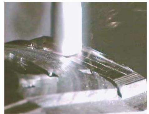
Bild 6: Werkzeugreparatur: Entfernen der beschädigten Bereiche
