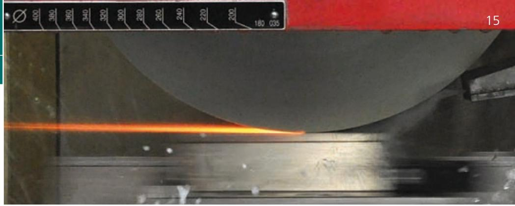
Minimalmengenschmierung beim Schnellhubschleifen einer Nickelbasislegierung mit höchsten Abtrennraten
