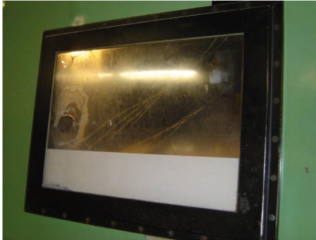
Bild 3: Sicherheitsfenster einer Werkzeugmaschine. Links im Fenster ist der Einschlag einer Spannbacke zu erkennen.
