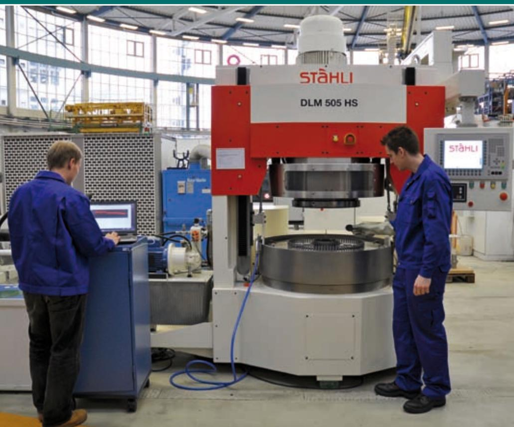
anspruchsvolle Aufgabe. Am Fraunhofer IPK werden derzeit innovative Verfahren für die Feinbearbeitung von Bauteilen aus C-SiC analysiert, wobei Untersuchungen an alternativen Schleifprozesskinematiken wie Pendelschleifen, Schnellhubschleifen und das in Bild 3 dargestellte Hochgeschwindigkeits- und Hochleistungsplanschleifen mit Planetenkinematik durchgeführt werden.
