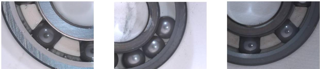
Abbildung 12. Limikroskopie-Aufnahme der Kugellager nach 1 Million Zyklen bei 100 N; a) unbeschichtetes Kugellager in HV; b) ta-C beschichtetes Kugellager in HV; c) ta-C beschichtetes Kugellager an Luft
