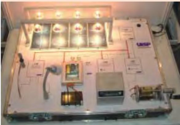
Abb. 1: Dieser Demonstrationskoffer zeigt ein voll funktionstüchtiges PV-Hybridsystem mit dem Universal Energy Supply Protocol UESP. Die Einzelkomponenten sind über einen CAN Bus miteinander verbunden und führen über ein standardisiertes herstellerunabhängiges Protokoll das kostenoptimierte Energiemanagement durch.
