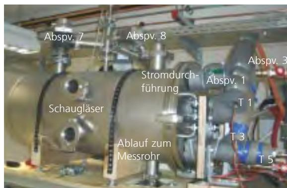
Abb. 4: Foto der Verdampferkammer des Messstands. In dieser vakuumdichten Kammer werden die unterschiedlichen Verdampferstrukturen (geflutet, berieselt) eingebaut. Es können Strukturen bis zu 2 kW Kälteleistung vermessen werden. Die Bilanzierung der Kälteleistung erfolgt über die Fluidseite, die Zuführungen und Temperatursensoren hierfür sind auf der rechten Seite der Anlage am Deckel zu erkennen.
