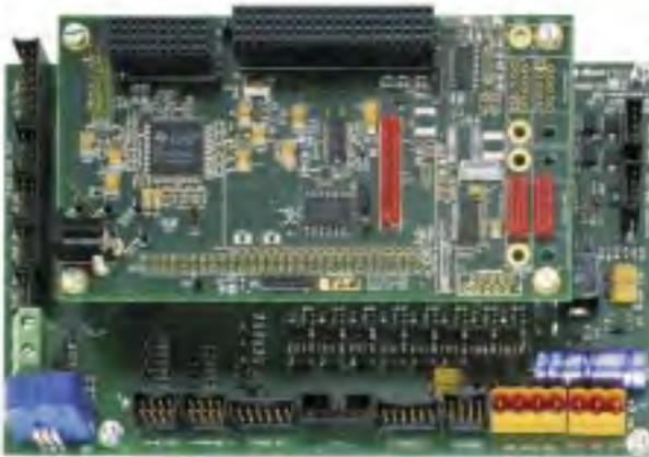
Abb. 1: Eine mikroprozessorbasierte Regelung und Sicherheitsüberwachung ermöglicht einen zuverlässigen Betrieb des Systems auf Knopfdruck. Das Bild zeigt die von uns entwickelte Platine mit Mikroprozessor.
