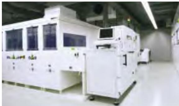
Abb. 4: Der Nasschemie-Cluster besteht aus einer Inline- und einer Batch-Vielzweckanlage sowie einem Chemikalienversorgungsmodul. Neben den Standardätzverfahren für mono- und multikristallines Silicium sind innovative Funktionen wie einseitiges Ätzen integriert. Die hierfür zur Verfügung stehende Analytik umfasst Titration, Chromatographie, Infrarot und Ultraviolett-Spektroskopie.
