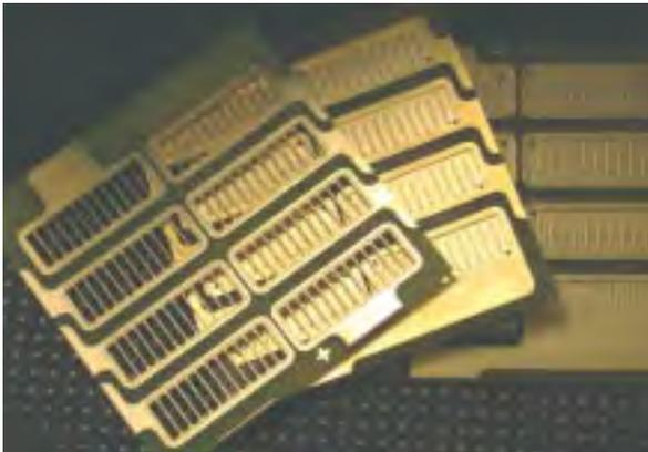
Abb. 1: Planare Brennstoffzellen können in Gehäuse integriert und passiv, d. h. ohne Lüfter oder Pumpen, betrieben werden. Wir verwenden kostengünstige Leiterplatten sowie Kunststoffmaterialien, deren Kanalstrukturen wir in jeweils optimierten Prozessen beschichten. Die serielle Verschaltung der acht Einzelzellen erfolgt in einer Ebene. Dadurch wird die Spannung erhöht und an die elektronischen Verbraucher angepasst.
