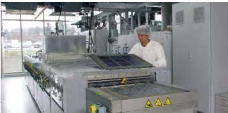
Abb. 1: Kathodenzerstäubungsanlage zur inline-Abscheidung von Aluminium und Siliciumnitrid.
