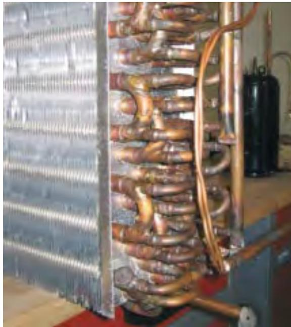
Abb. 1: Mit diesem neu entwickelten Kombiverdampfer<sup>1</sup> können zwei Wärmequellen wie z. B. Abluft und Solarenergie gleichzeitig von der Wärmepumpe genutzt werden, ohne den Kältekreis dafür komplexer gestalten zu müssen. Das Kältemittel im Ringspalt der Koaxialrohre kann Wärme von der Flüssigkeit im Innenrohr und gleichzeitig von außen aus dem Luftstrom aufnehmen.
