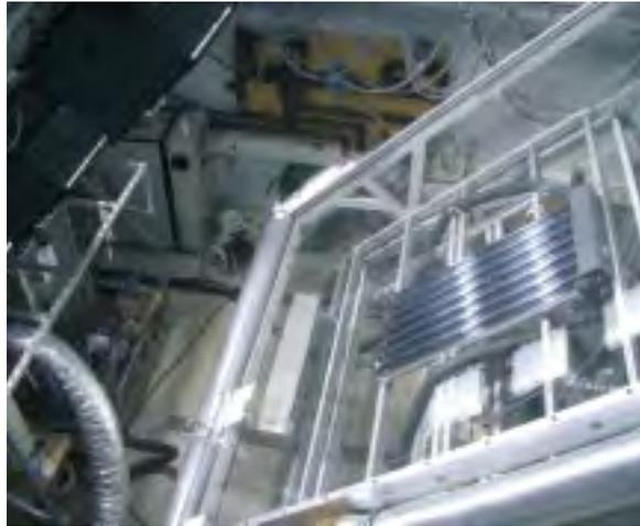
Abb. 1: Wirkungsgradkennlinienmessung eines Vakuumröhrenkollektors mit CPC-Reflektor unter dem Solarsimulator des Fraunhofer ISE. Links unten im Bild steht der neue Teststand, mit dem wir exakte Messungen bis 200 °C durchführen können. Der Teststand ist transportabel konzipiert, so dass wir ihn auch mit dem Freiluft-Teststand mit Tracker und natürlicher Solarstrahlung einsetzen können.
