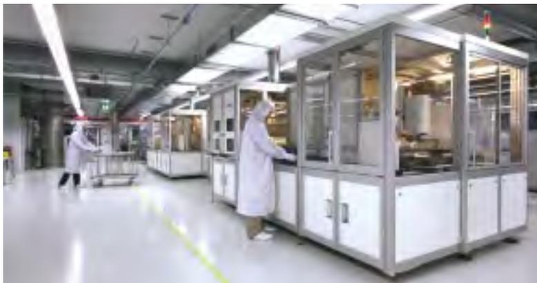
Abb. 1: Im PV-TEC stehen modernste Fertigungsanlagen zur Verfügung. Zur Grundausstattung gehören: Batch Multifunktionsnasschemieanlage, in-line Texturanlage, Rohrdiffusion/-oxidation, Plasmaunterstützte Gasphasenabscheidung (PECVD), Sputterbeschichter, Siebdrucklinie, Laseranlage, Solarzellentester und -sorter. Schnelle Inline-Messgeräte sind in die Anlagen integriert.
