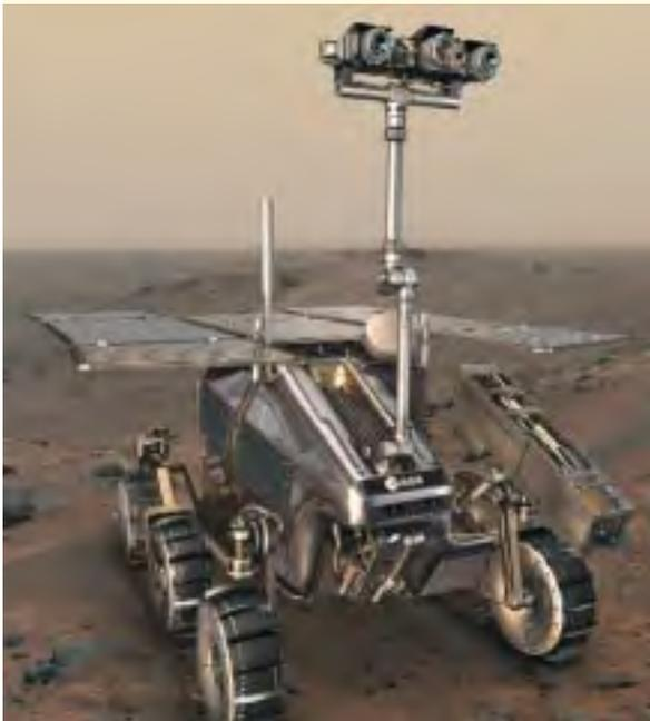
Abb. 1: ExoMars ist ein geplanter europäischer Mars-Rover, der im Rahmen des Aurora-Programms 2013 von Kourou aus gestartet werden soll. Die Stromversorgung des rund 190 kg schweren Rovers erfolgt über III-V Mehrfachsolarzellen.
