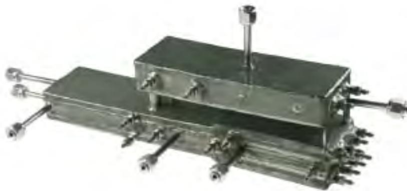
Abb. 3: Foto der Hochtemperatureinheit. Auf der linken Seite sind der Verdampfer und der Überhitzer zu sehen, rechts unten schließt sich der eigentliche Dampfreformierreaktor an. Darüber sitzt der zweistufige Shift-Reaktor. Die diversen Rohrstützen dienen der Zu- und Ableitung der Stoffströme sowie dem Anschluss von Thermoelementen.
