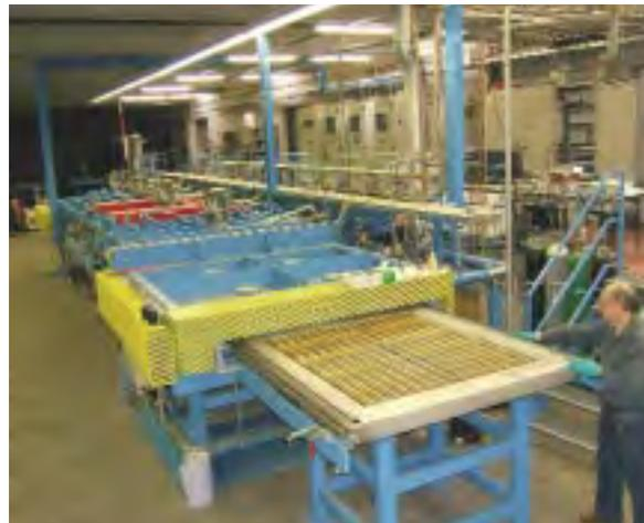
Abb. 3: Sputteranlage zur Beschichtung der Stahlrohre mit Absorberschichten und der Gläser mit Spiegelschichten.
