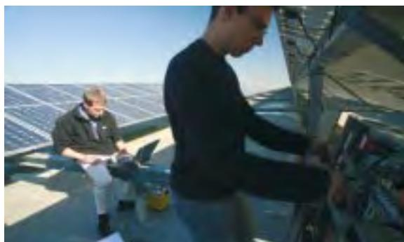
Abb. 2: Fraunhofer ISE-Experten bei der Leistungsvermessung der 3 MW-Anlage auf dem Dach der Produktionshalle des BMW-Werks Dingolfing.
