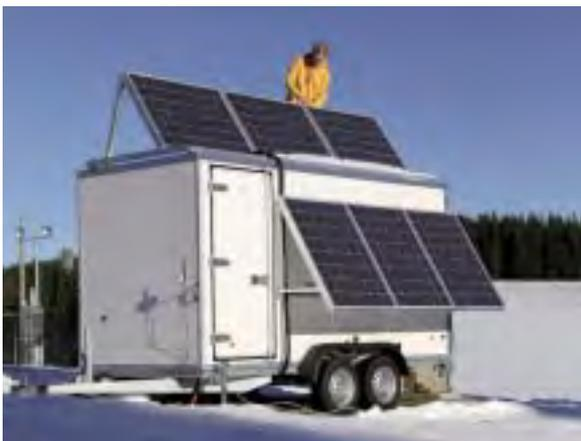
Abb. 3: »EVEREST«-Maxibox, bestehend aus einer Photovoltaik-Anlage (960 Wp) auf dem Dach bzw. an der Seite des Hängers sowie einer Direktmethanol-Brennstoffzelle (325 W) und Batterien mit einer Kapazität von 1320 Ah im Innenraum. Für den Transport des Messsystems (Abb. 2) im mobilen Einsatz ist die Maxibox als Hänger konstruiert.
