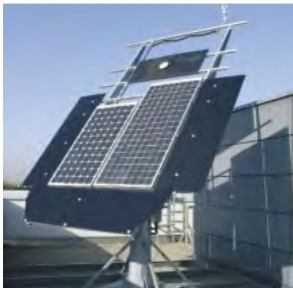
Abb. 2: Prüfstand zur Bestimmung der »Nominal Operating Cell Temperature« (NOCT). Der einachslich nachgeführte Tracker ermöglicht eine Verkürzung der notwendigen Prüfzeiten.
