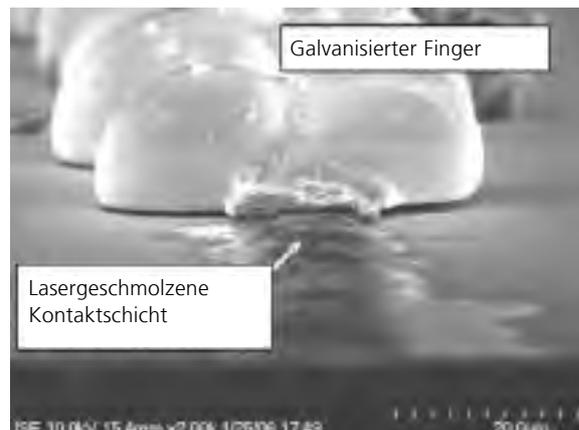
Abb. 3: REM-Aufnahme einer Metallsaatschicht, die mittels Laseraufschmelzen eines Metallpulvers (LAPO) erzeugt wurde. Im oberen Teil des Bildes ist die Verdickung dieser Saatschicht mittels lichtinduzierter Galvanik zu erkennen.
