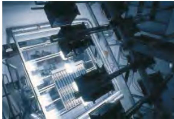
Innen-Teststand mit Solarsimulator.
