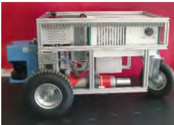
Abb. 2: Zusammen mit dem Fraunhofer IAIS entwickeln wir ein Brennstoffzellen-Stromversorgungssystem für die »VolksBot RT 3-wheeled« Robotikplattform. Die Abbildung zeigt eine dreirädrige Version (BxHxT: 540x410x630 mm<sup>3</sup>), in die bereits das Brennstoffzellensystem integriert wurde. Der in blau kenntlich gemachte Laserscanner am vorderen Ende dient der Navigation.
