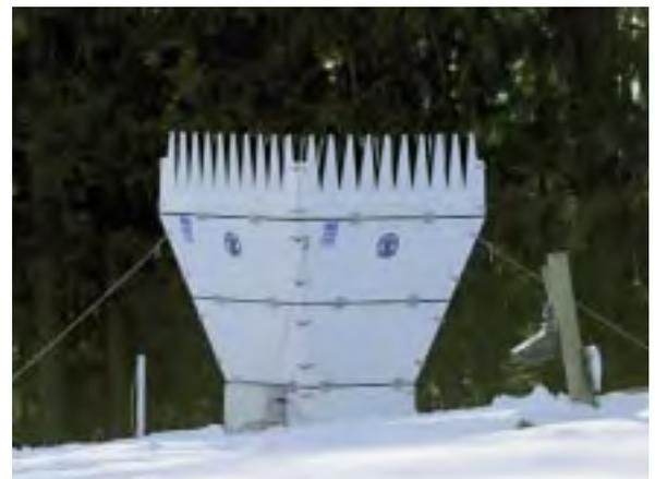
Abb. 2: »Doppler-Sodar-Messsystem PCS.2000- 24« der Firma Metek. Versorgt wird diese mobile Messstation mit der »EVEREST«-Maxibox (Abb. 3).
