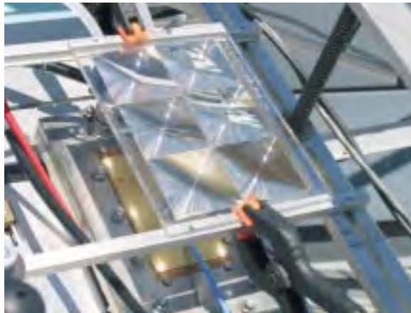
Abb. 1: HyCon® Prototyp zur Erzeugung von solarem Wasserstoff bei der Außenmessung.
