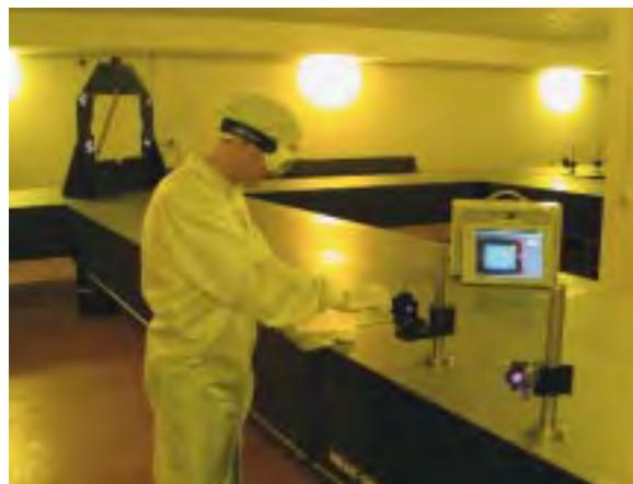
Abb. 2: Das Fraunhofer ISE Interferenzlithographielabor. Hier können Gitterstrukturen auf Flächen von bis zu 1,2 x 1,2 m<sup>2</sup> homogen erzeugt werden.
