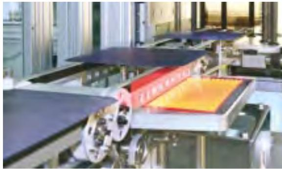
Abb. 2: Im PV-TEC Charakterisierungslabor können verschiedene hochauflösende Messungen durchgeführt werden. Die wichtigsten Messplätze sind: Infrarot-Multifunktionsmessplatz, großflächige Externe Quanteneffizienz, ortsauflösende Lebensdauerermessung, Schicht- und Kontaktwiderstandstopographie, Reflexion spektral aufgelöst. Inline-Messgeräte sind in die Anlagen integriert.
