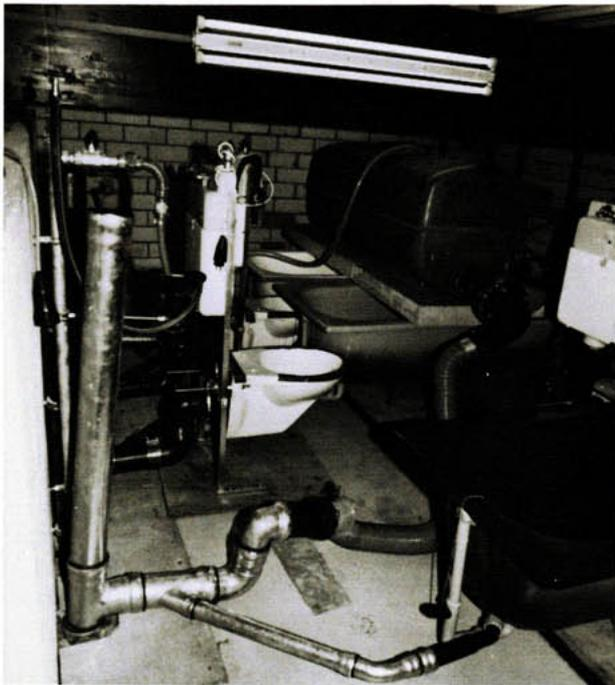
**Bild 2:** Untersuchungen verschiedener Abwasser-Rohrsysteme: Wannen-, WC- und Dachentwässerungs-Anschlüsse im DG des Installations-Prüfstandes
