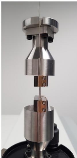
Abbildung 3.21: Drahtdurchführung seitlich an Probe entlang
