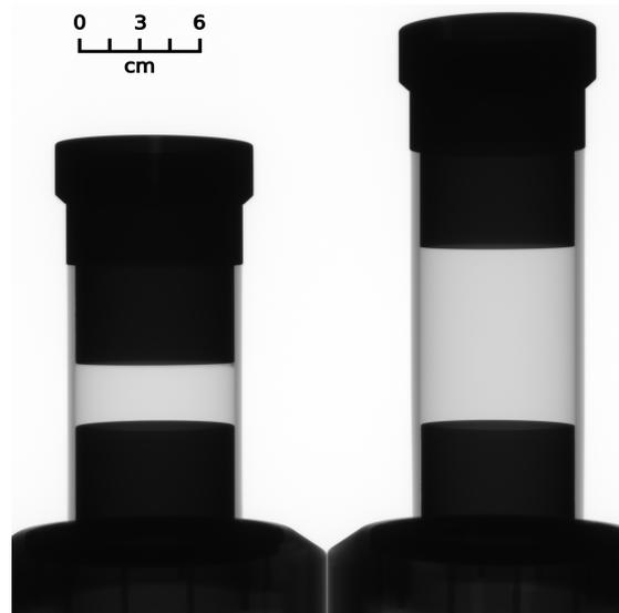
Abbildung 3.16: Durchstrahlungsaufnahme der beiden Zylinder zur Bestimmung der Abmessungen
