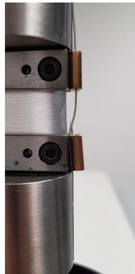
Abbildung 3.22: Befestigung des Draht an der Einspannung der Probe
