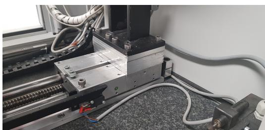
Abbildung 4.5: Unterbau für den Detektor
