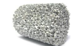
Bild 4 SSiC-Schaum mit Washcoat.
