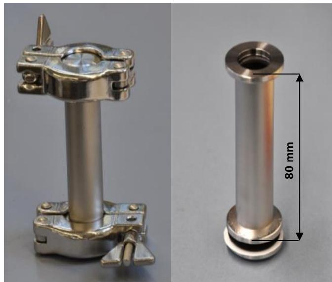
**Abbildung 3.3-2** Bilder der Extraktionseinheit. Rechts ist die PVC-Folie zu sehen (weißes Material).
