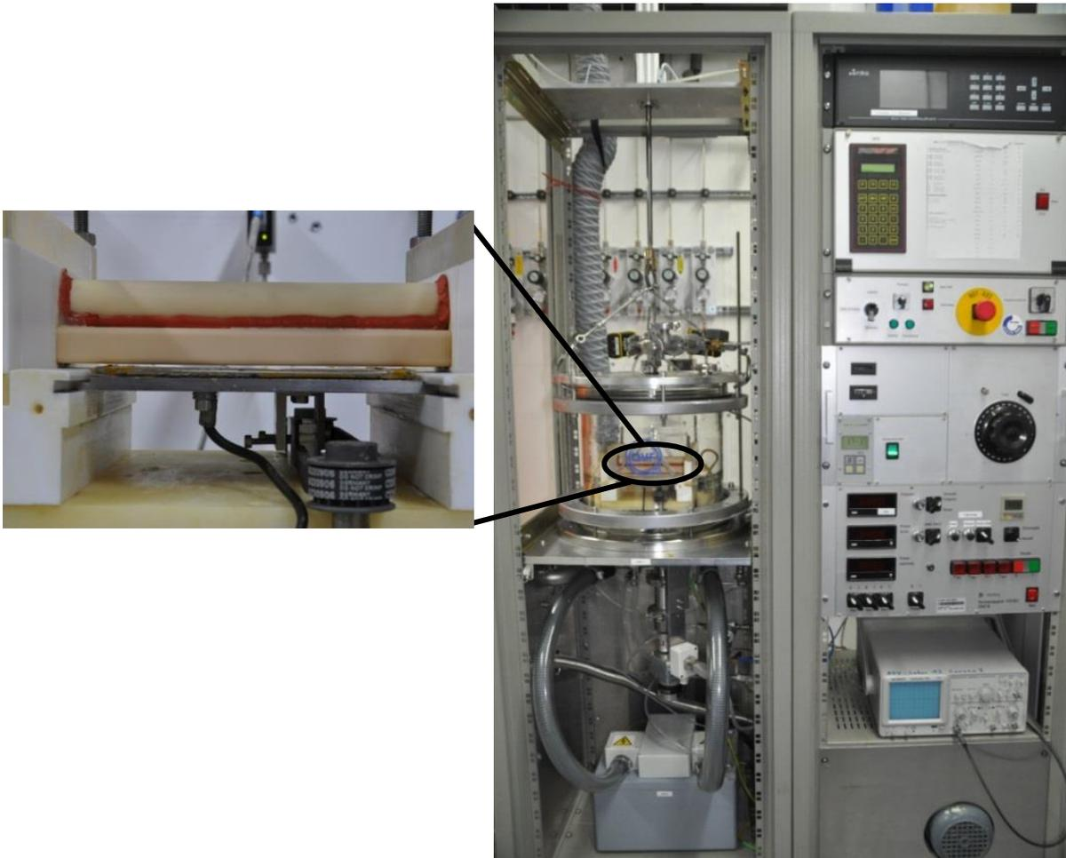
**Abbildung 3.2-1** Aufbau der Plasmaanlage (DBD I), rechts, und der Elektroden, links [Blu10].
