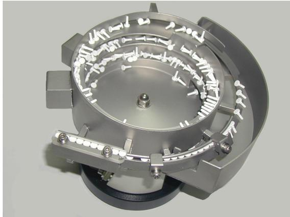
Abb. 6.4: Abbildung eines Vibrationswendelförderers (engl.: *Bowl Feeder*) [Feeder].
