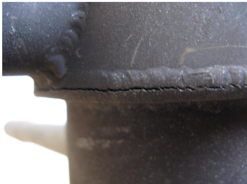
Abbildung A.13: Biogas v1.0: Schweißnaht am Start- und Nachbrenner
