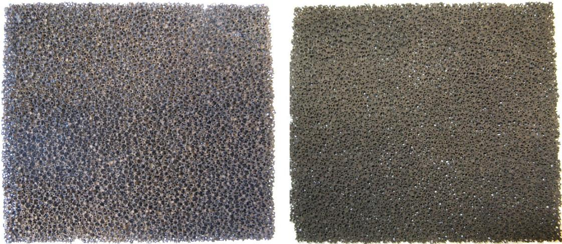
Abbildung A.36: Biogas v2: Reformingkatalysator vor (l) und nach (r) den Komponentenversuchen
