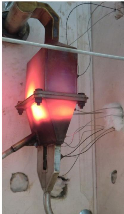
Abbildung A.29: Biogas v2: Teststandsstartbrenner in offener, unbefüllter Hotbox
