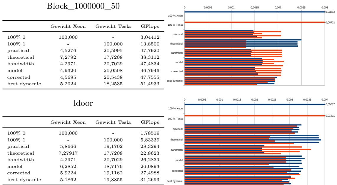
**Abbildung 7.13.:** Balancierungsbetrachtung für die Gewichtungsansätze: Balance zwischen vier Xeon-Prozessoren und vier Tesla-Karten auf dem Bull
