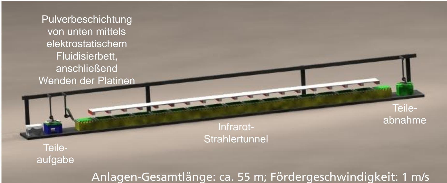
**Stark vereinfachtes Konzept einer wandlungsfähigen Anlage zur Pulverbeschichtung von bereits vorbehandelten Blechzuschnitten (Platinen)**
