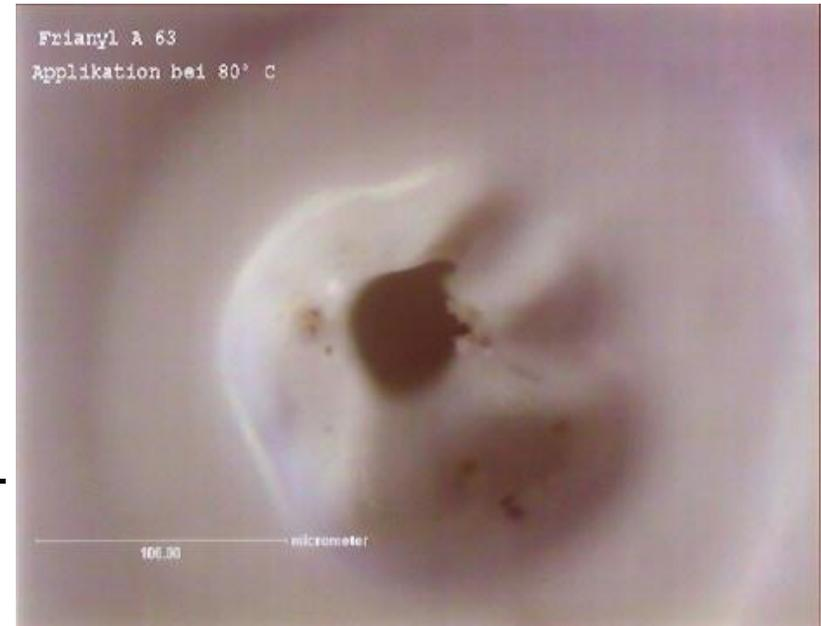
Lackierfehler durch Ausgasung aus Kunststoffsubstrat beim Einbrennen
