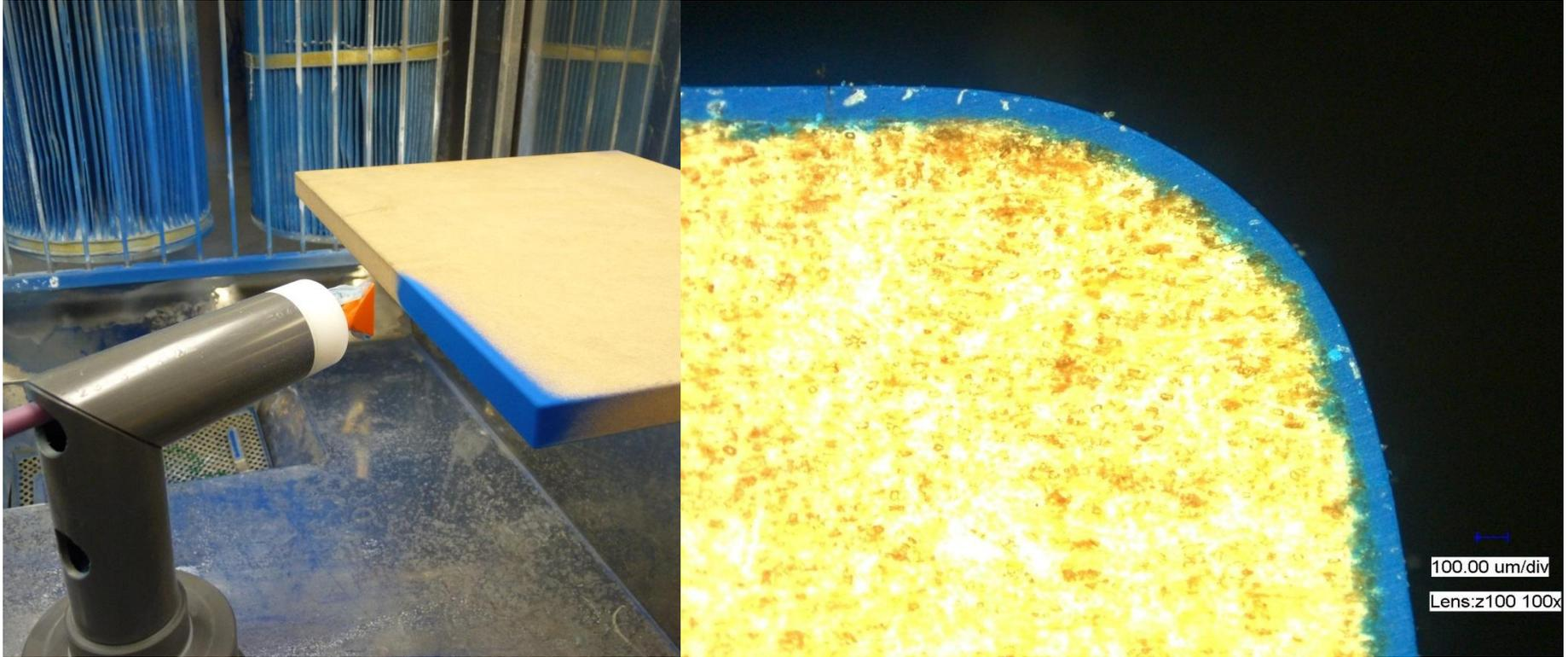
Ausführungsform mit spezieller Flachstrahldüse zur selektiven Beschichtung schmaler Flächen (Fraunhofer IPA)
