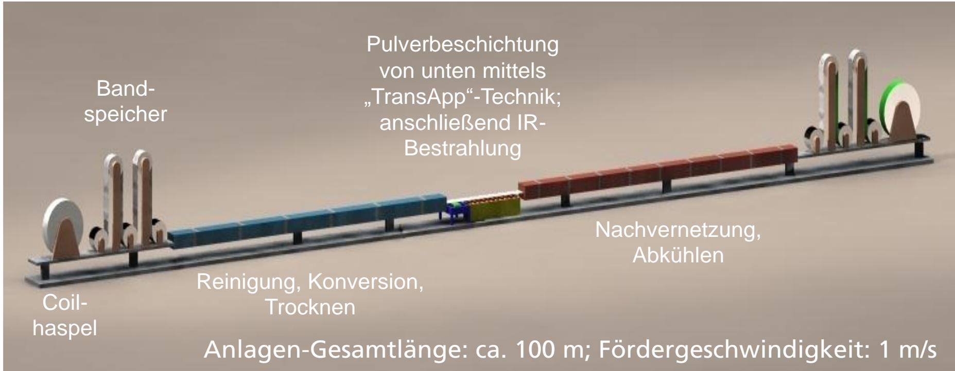
**Stark vereinfachtes Konzept einer Hochgeschwindigkeits-Pulverbeschichtungsanlage für Coil**
