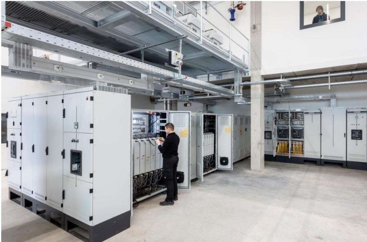
Abbildung 22: 1-MW-Netzsimulator im Multi-Megawattlabor am Fraunhofer ISE
