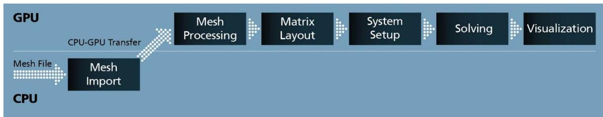
Abbildung 1: Übersicht der Berechnungen, die auf der CPU und GPU ausgeführt werden.
