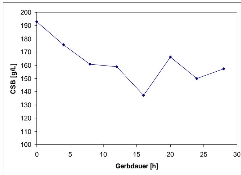
**Abbildung 25: Chemischer Sauerstoffbedarf der Restgerbflüssigkeiten in Abhängigkeit der Gerbdauer**
