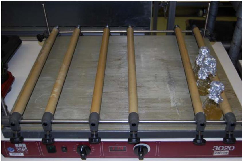
**Abbildung 21: Schüttelmaschine**
