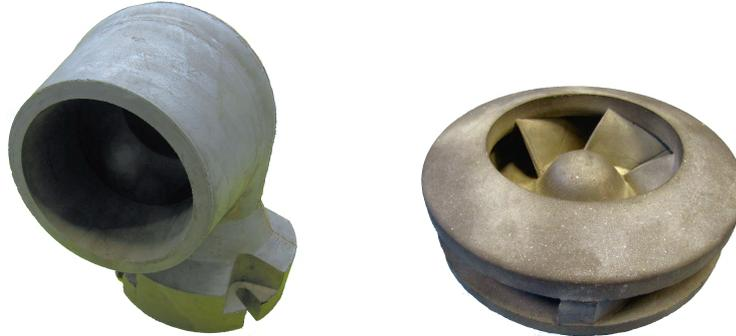
**Bild 5.2:** Auswahl hergestellter Musterbauteile aus SiSiC; *links:* Umlenkdüse (240 x 290 x 265 mm<sup>3</sup>); *rechts:* Radialpumpenlaufrad (Ø 259 mm)
