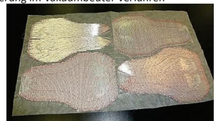
Tailored Fiber Placement Halbzeug: Verstärkungs- und Matrixfasern (Glasfaser/PBT-Hybridgarn) auf Trägerschicht
