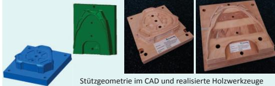
Stützgeometrie im CAD und realisierte Holzwerkzeuge
