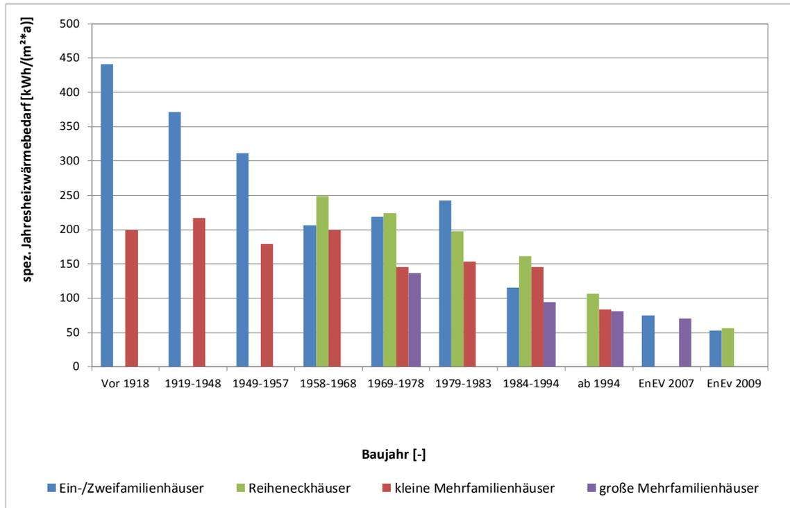
Abbildung 3-5: Entwicklung des spezifischen Jahresheizwärmebedarfs verschiedener Gebäudetypen in Abhängigkeit des Baujahres (Klimaregion Essen)
