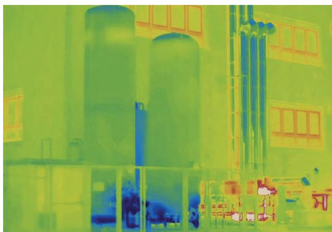
*Ein optisches Messsystem ortet Leckagen an Biogasanlagen aus mehreren Metern Entfernung. Gemessen wird die thermische Strahlungsemission des Gases, die durch spezifisch eingestrahktes Laserlicht angeregt wird.*
