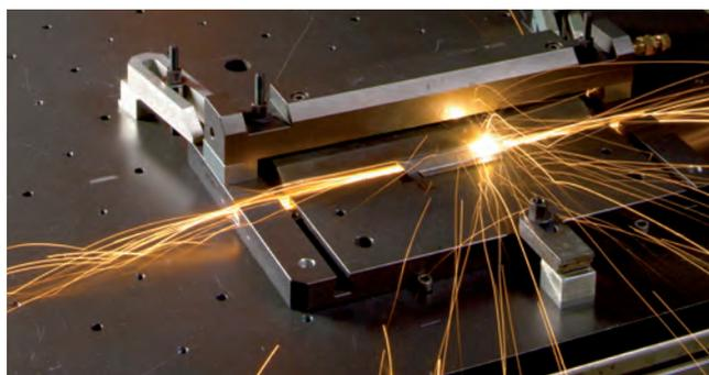
*Die Einschweißtiefe beim Laserschweißen lässt sich mithilfe von Lichtlaufzeitmessungen ermitteln. In Kombination mit einem konfokalen Messverfahren sollen zukünftig höhere Tiefenaufösungen erreicht werden.*
