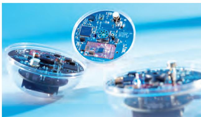
*Mobile Roboter streuen im Katastrophenfall miteinander vernetzte Sensorkugeln über das Gelände. Diese lokalisieren Gefahrenquellen wie giftige Gase oder Chemikalien und informieren die Rettungskräfte.*
