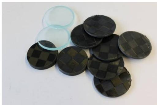
Abbildung 7-3: Probekörper für die Thermogravimetrische Analyse
