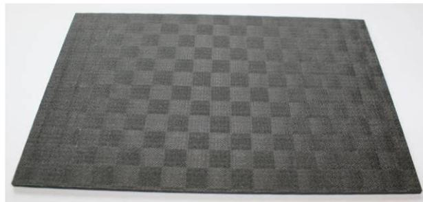
Abbildung 7-5: Pyrolyseplatte für Einzelfaserzugversuche
