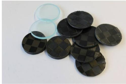
Abbildung 7-15: Probekörper für die Thermogravimetrische Analyse
