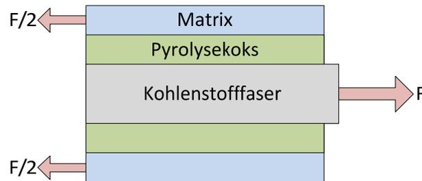
Abbildung 7-37: Pyrolysekoks auf rC-Faser
