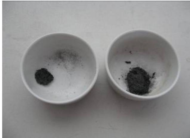
Abbildung 6-4: Pyrolyserückstände in Keramikschaalen
