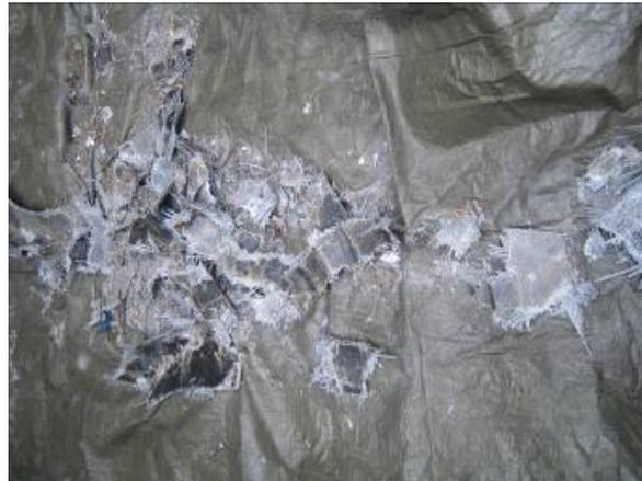
*Abbildung 9-1: Im MPA-Shredder zerkleinertes CFK-Bauteil*
