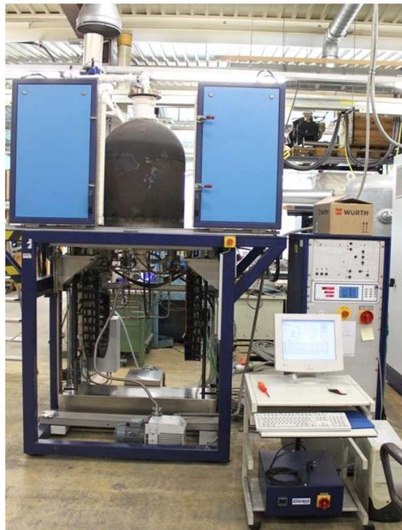
Abbildung 7-10: Haubenofen für Vakuum- und Schutzgasbetrieb
