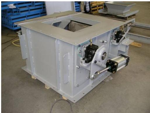
Abbildung 10-4: Klappenschleuse<sup>13</sup>
