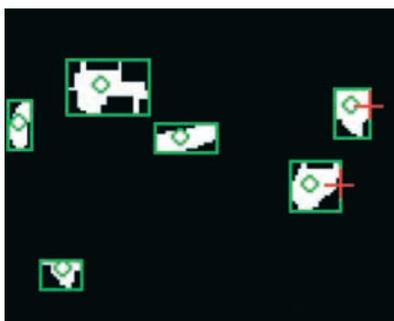
Bild 2: Reflexionsmarken auf dem Roboterarm, Hauttöne
