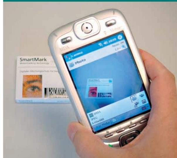
Bild 3: Mobile Überprüfung der Authentizität von Verpackungen mit Hilfe von Standardgeräten
