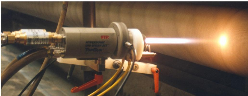
**Bild 2. Hochgeschwindigkeitsflammspritzen (HVOF)**
