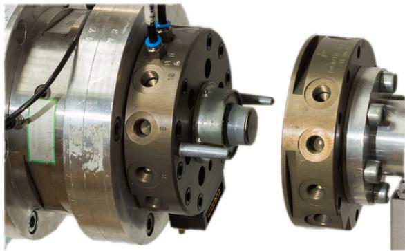
(a) Werkzeugwechsler an Roboter (links) und Werkstück (rechts).
