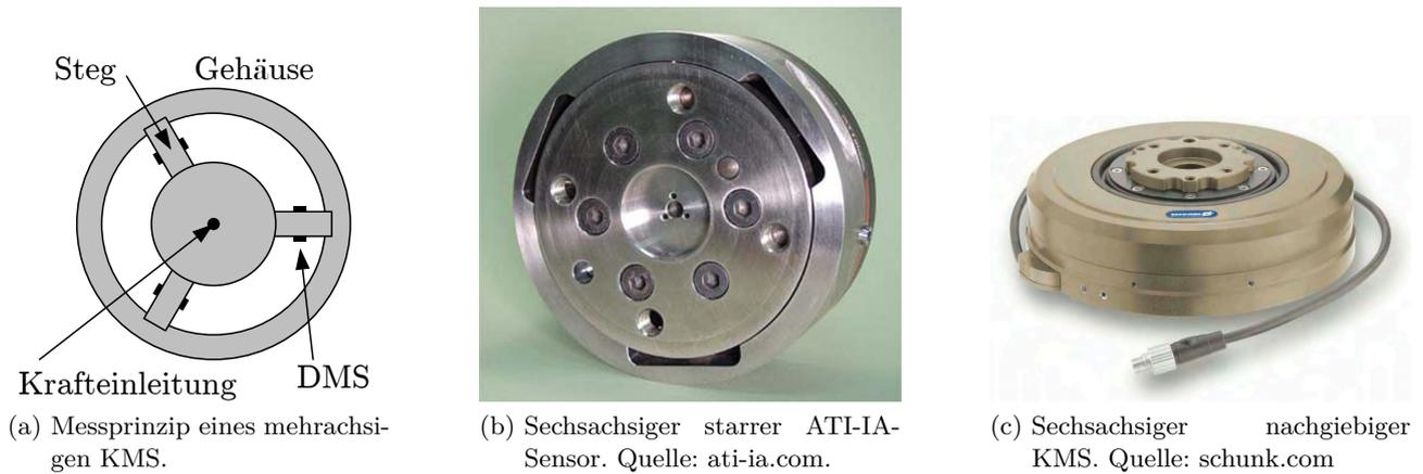
Abbildung 2.10: Mehrdimensionale Kraftsensoren.
