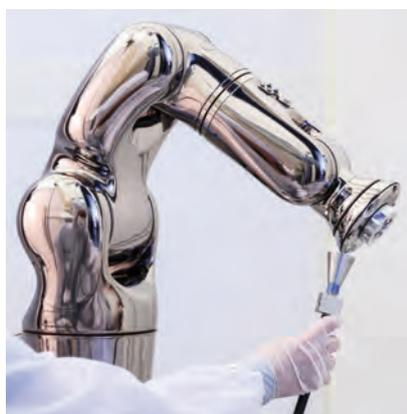
Abbildung 1: Messsonde eines Partikelzählers unter einem tribologischen Element zur Bestimmung der Partikelemissionen in einer ISO-Klasse 1-Umgebung nach ISO 14644-1 (Quelle alle Abbildungen: Fraunhofer-Institut für Produktionstechnik und Automatisierung IPA).
