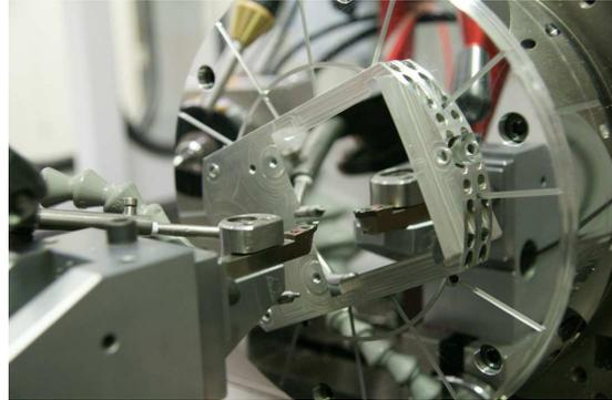
(b) Spiegelmodul M2/M3 auf der UP-Bearbeitungsmaschine; Spiegelfläche M3 fertiggestellt; M2 nicht montiert
