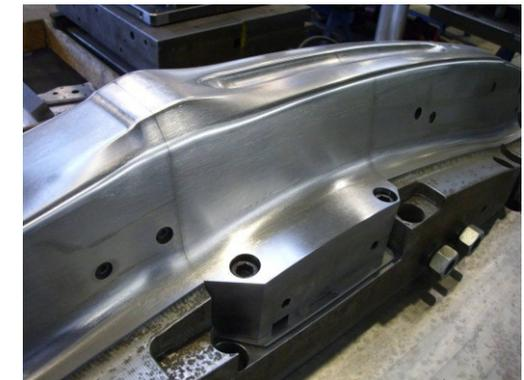
Werkzeugeinsatz montiert im Gesamtwerkzeug
