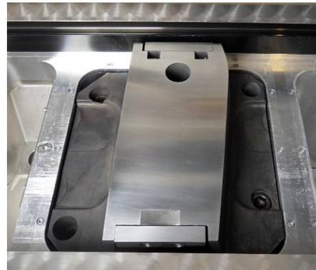
gefräster Grundkörper in der Laserstrahlschmelzanlage (Material - 1.2367)
