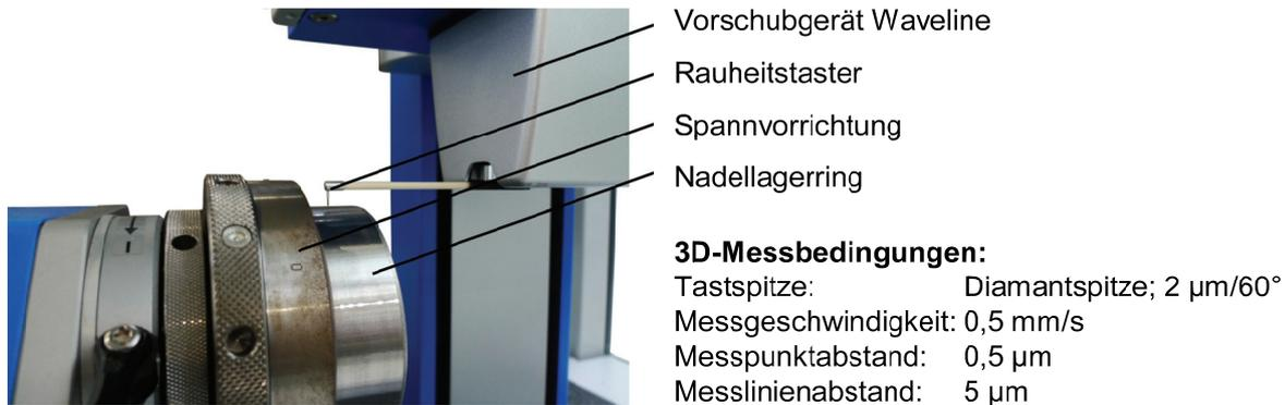
Bild 7-7: Messbedingungen für die taktile 3D-Oberflächenvermessung der Lagerringe aus 100Cr6
