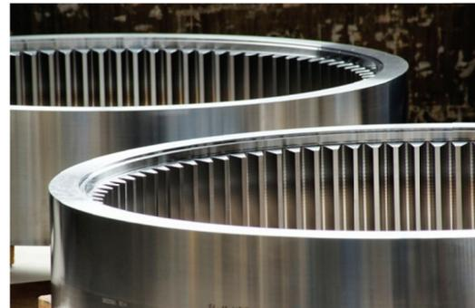
Bild 2-1: Zahnradarten [ZAH15]; a) Ritzelwellen, innen- und außenverzahnte, gerad- und schrägverzahnte Stirnräder; b) innenverzahnte Stirnräder für Planetengetriebe
