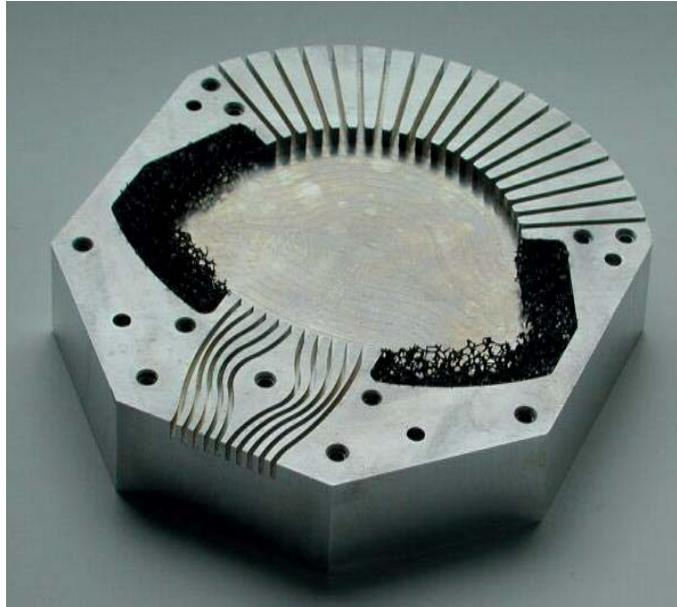
Abbildung 2: Foto der ersten Hohlleiterlinse für das W-Band [42].
