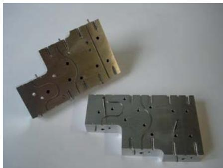
Abbildung 24: Foto der geätzten Referenzleitungen.
