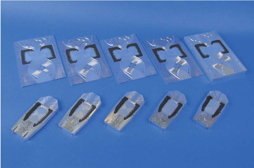
Abbildung 93: Foto des zerlegten Linsenstapels mit den 4 Antennenlinsen aus gewalztem Aluminium. Die unterste Linse dient als Bodenplatte und wird in eine 10 mm starke Aluminiumplatte gefräst. Die 5 Speiselinse werden als identische Exemplare gefertigt.
