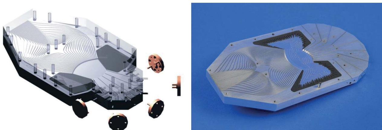
Abbildung 57: 3D-AutoCad-Skizze und gefertigte Rotman-Linse für 220 GHz, links: erster Entwurf mit 5 Fokusports, rechts: zweiter Entwurf mit 9 Fokusports.
